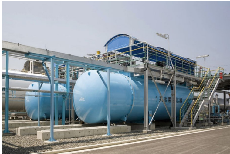
Slika 3.5 Uređaj za ukapljivanje vodika [1].
