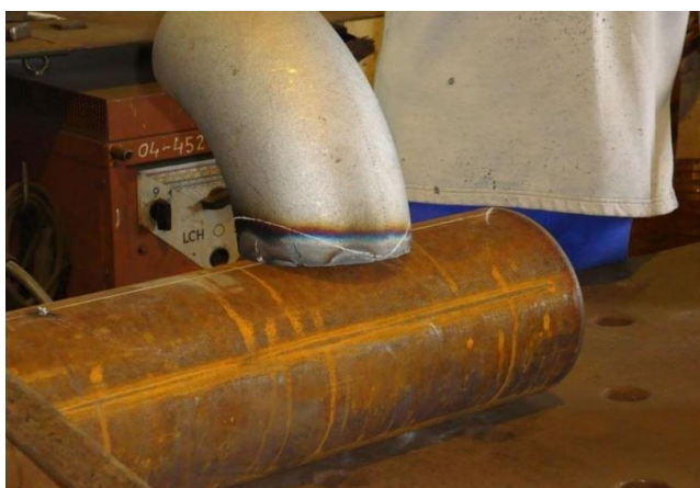
Slika 3.8. Trasiranje i ručno rezanje ogranaka pomoću plinskog plamenika
