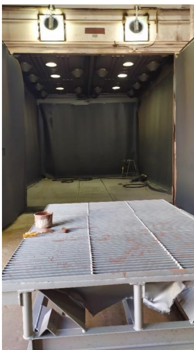
Slika 3.16. Komora za sačmarenje
