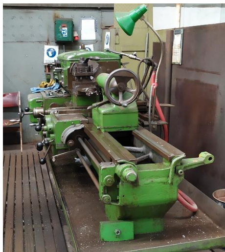
Slika 3.6. Stroj za tokarenje krajeva cijevi
