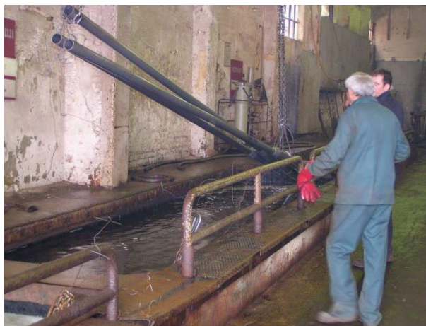
Slika 3.17. Kada za neutralizaciju nakon tretiranja kiselinom
