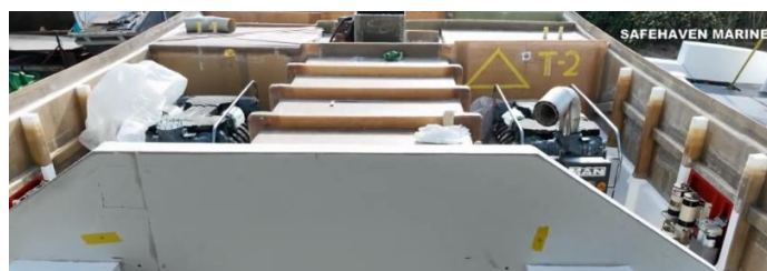
Slika 2.12. Prikaz ojačanja u strojarnici na stvarnom katamaranu [14]
