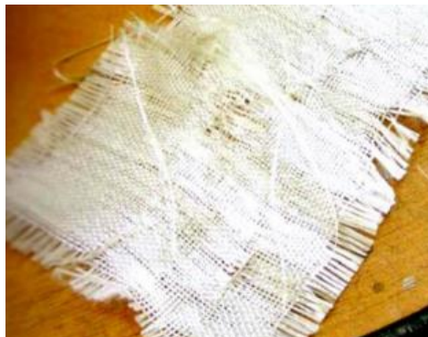
Slika 1.2. Konfiguracija pređe biaxial 0^{\circ}/90^{\circ} [2]
