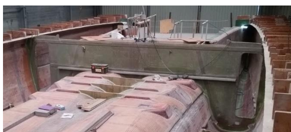
Slika 2.11. Prikaz poprečne pregrade i nosača u stvarnosti [13]
