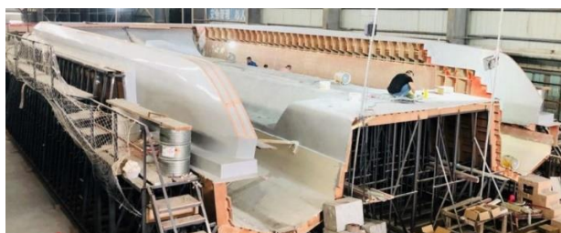
Slika 2.4. Prikaz trupa bez krmenih zrcala u stvarnosti [12]
