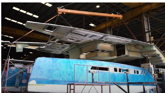
Slika 2.21. Prikaz spajanja glavne palubne i trupa u stvarnosti [15]
