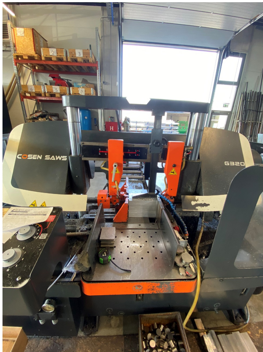
Slika 4.1.1. Rezanje sirovca Podloge na Cosen G320 pili
