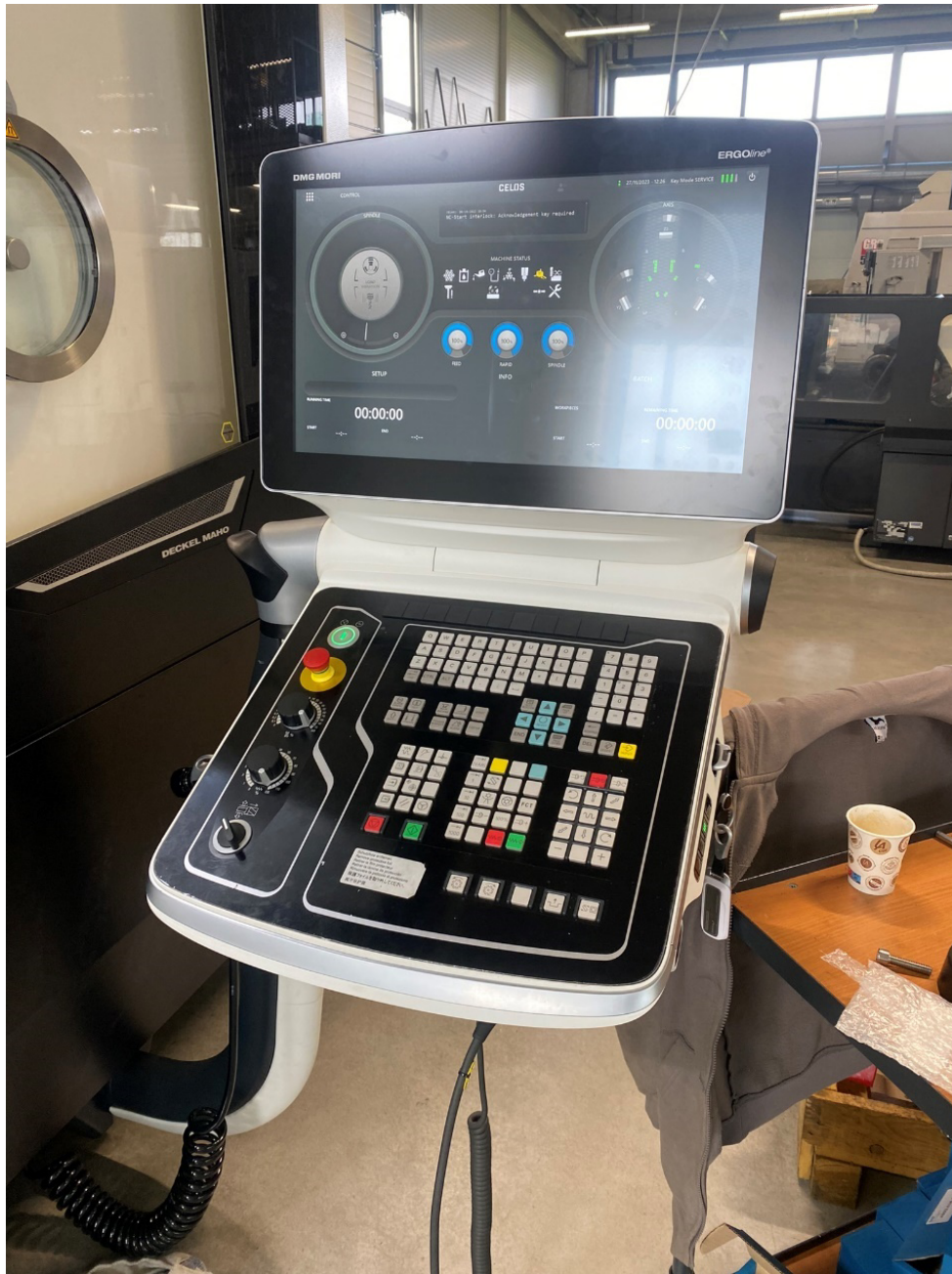
Slika 3.3.1. Upravljačka jedinica Siemens Sinumerik 840D u integraciji sa Celos platformom
