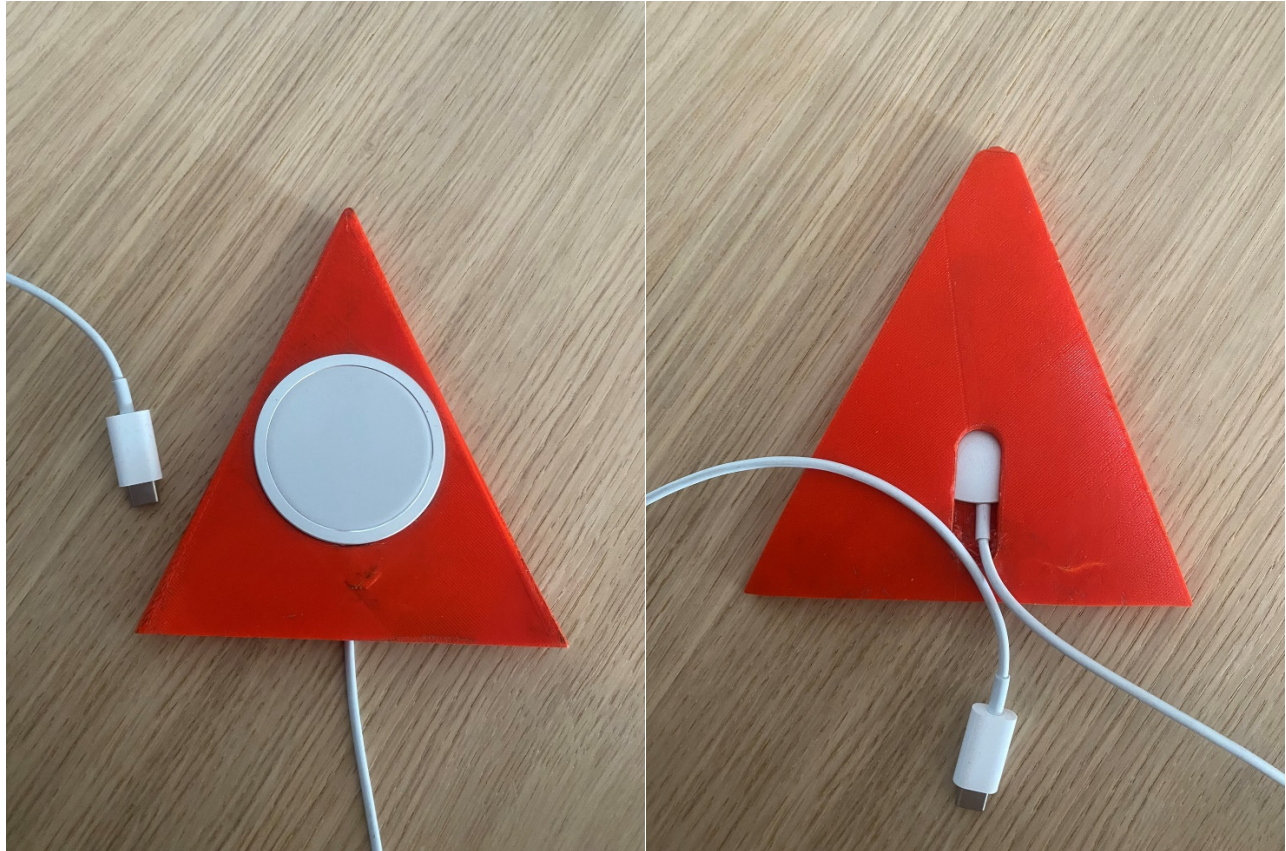
Slika 2.1.1. Ispisani prednji dio prototipa i Slika 2.1.2. Ispisani stražnji dio prototipa
