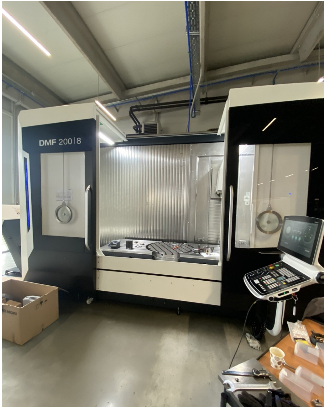
Slika 3.3.2. Petoosna glodalica DMF 200 | 8
