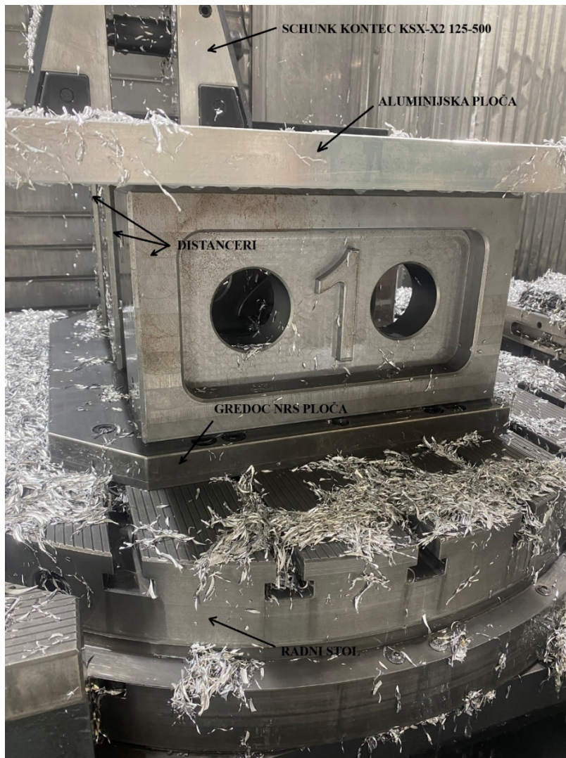
Slika 4.2.1. Stezni sustavi na radnom stolu
