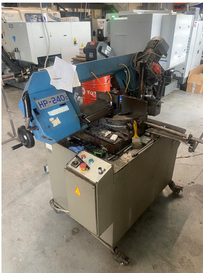
Slika 4.1.2. Horizontalna tračna pila HP-240C
