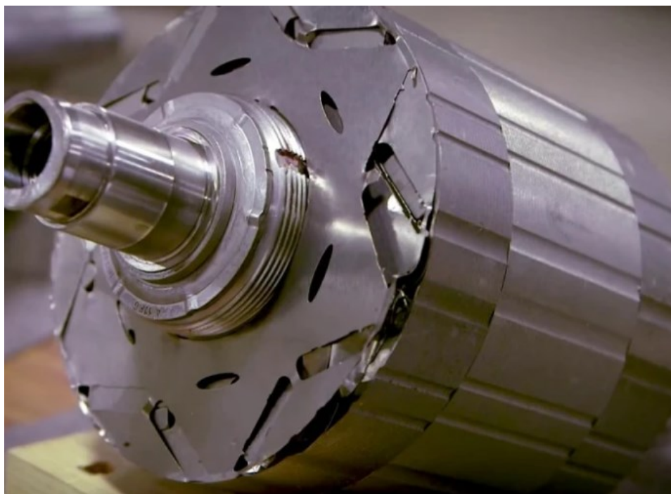
Slika 2.9. – Rotor IPMSM stroja iz električnog vozila [8]
