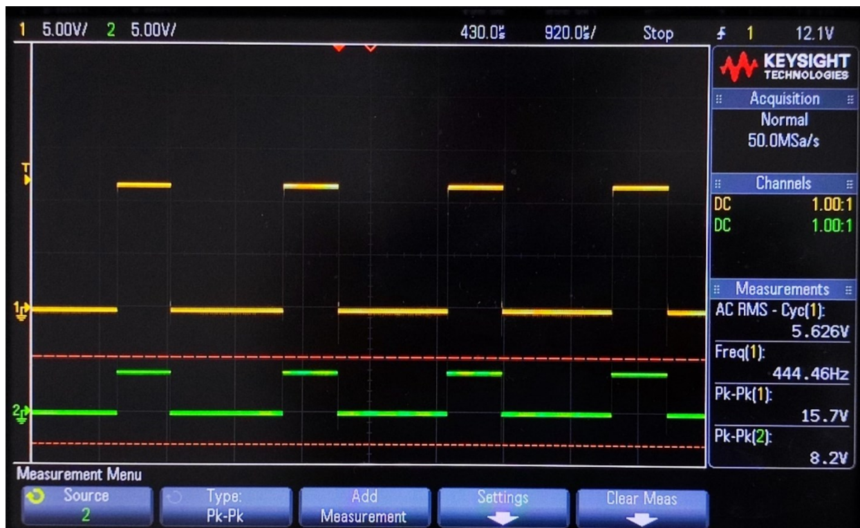
Slika 6.2. - Valni oblici upravljačkih signala
