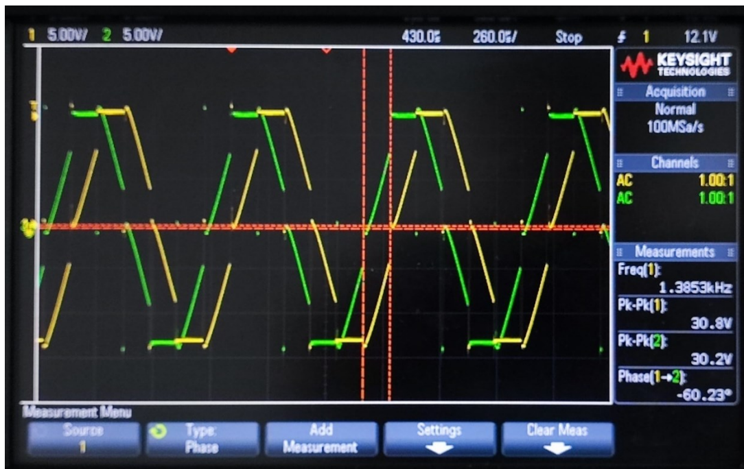
Slika 6.10. - Valni oblici napona dvije faze
