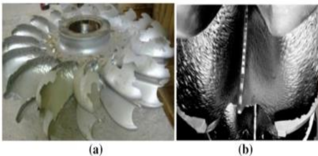
Slika 6.6. Erozijska šteta na lopaticama Pelton turbine [13]
