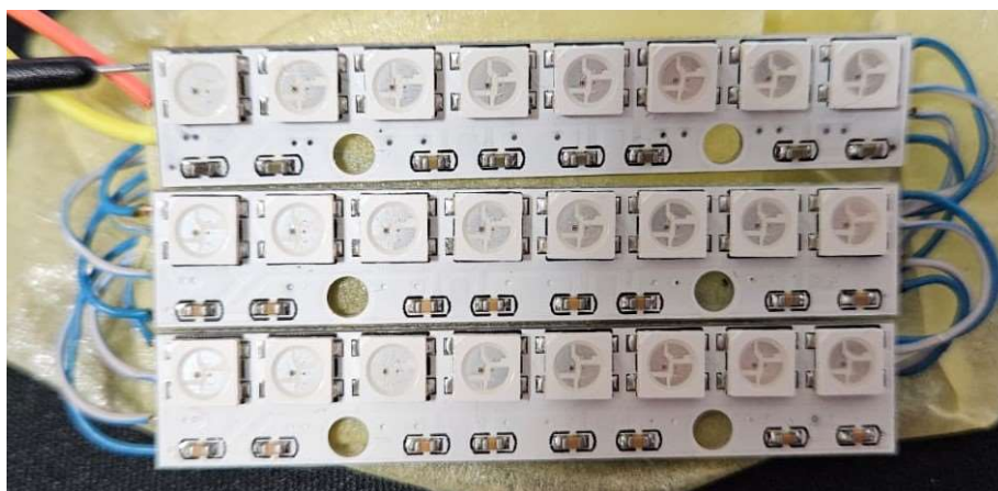
Slika 3.6. Tri WS2812B-8 modula raspoređenih u 8x3 matricu.
