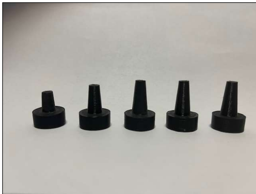
Slika 3.6 Iteracije tijekom izrade oslonca
