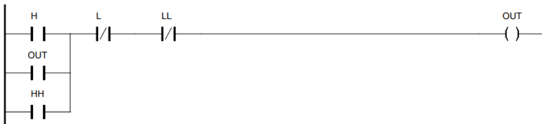
Slika 5.7. Blok automatskog režima rada
