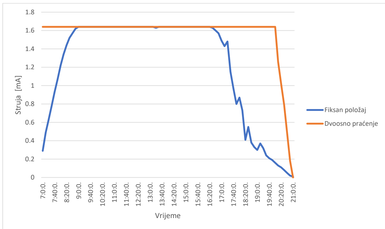
Slika 11.5. Usporedba izračunatih struja pri dvoosnom praćenju položaja Sunca te fiksnom položaju solarnog panela.
