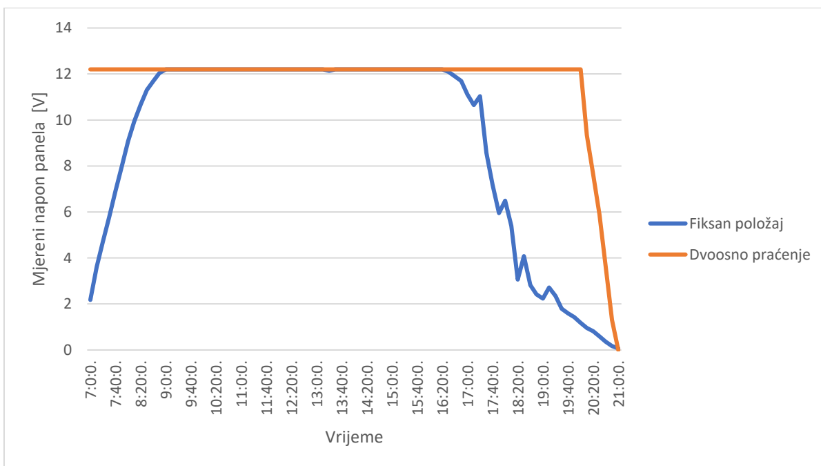
Slika 11.4. Usporedba mjerenih napona pri dvoosnom praćenju položaja Sunca te fiksnom položaju solarnog panela.
