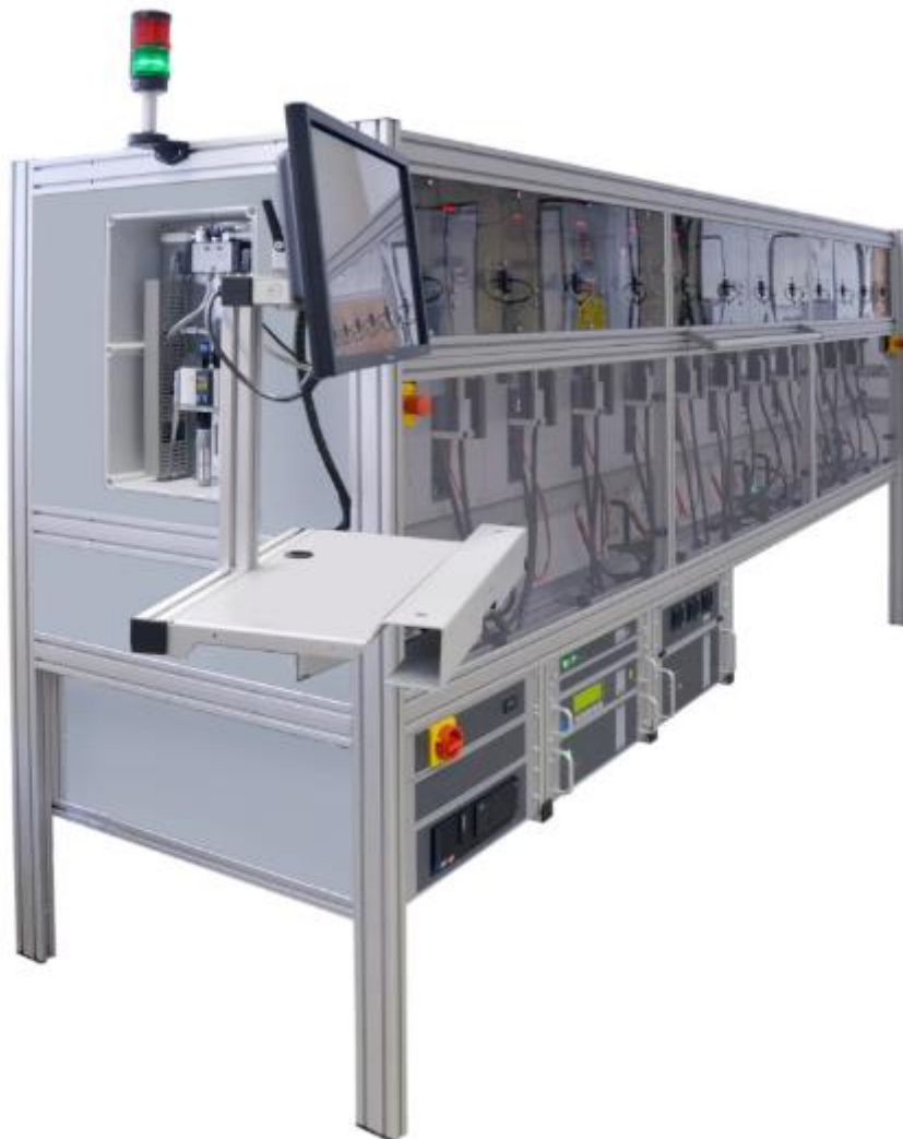
Slika 5.2.1 GFUVE profesionalni sustav za umjeravanje dvadeset brojila [16.]
