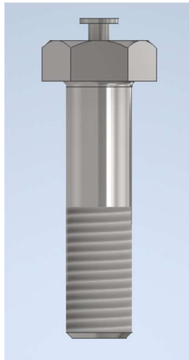
Slika 2.5. Vijak M12 sa svornjakom M4
