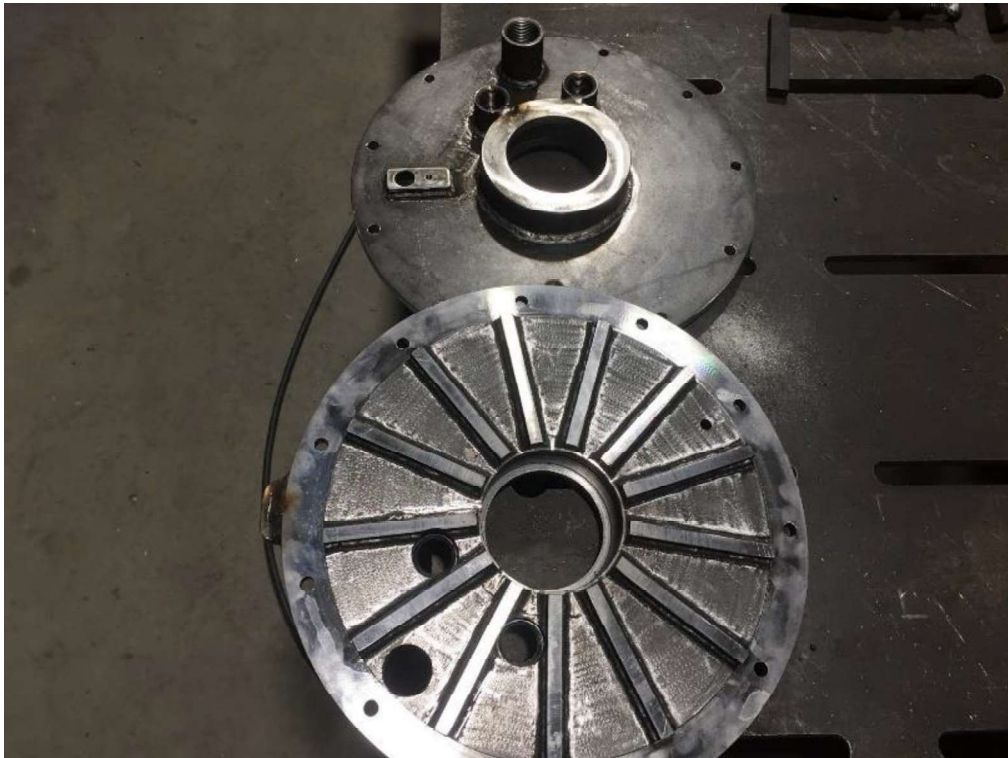
Slika 3.2. Primjer statora jednostavne hidraulične kočnice [3]
