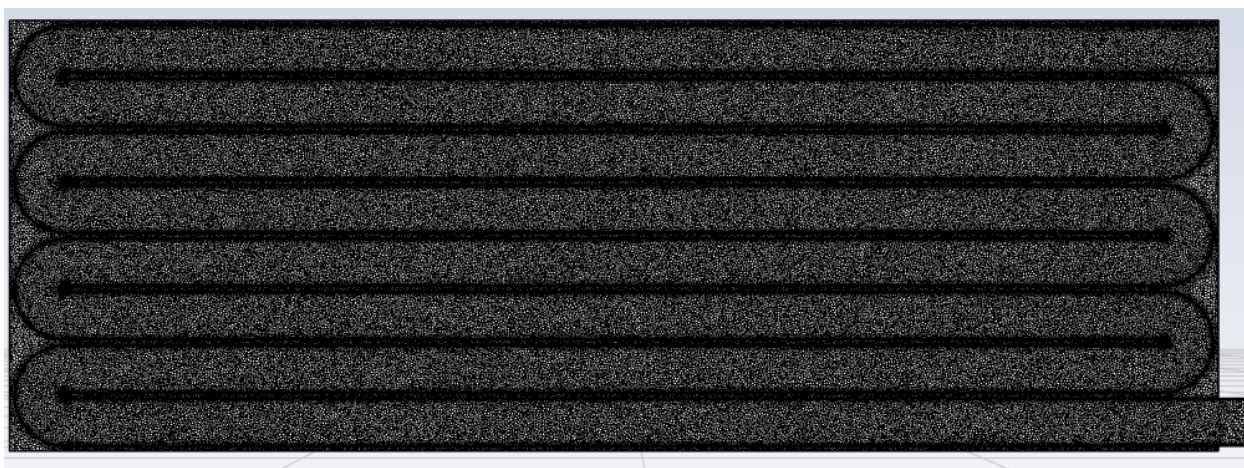
Slika 4.17 Tlocrtni prikaz numeričke mreže zmijolikog cjevovoda
