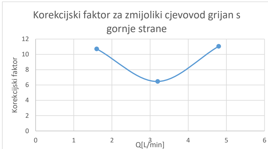
Graf 7.4 Korekcijski faktor zmijolikog cjevovoda grijanog s gornje strane
