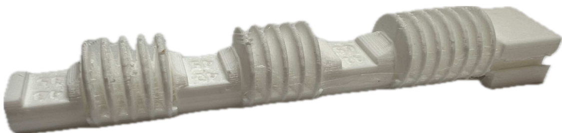
Slika 5.8. Isprintani model mekog robota.
