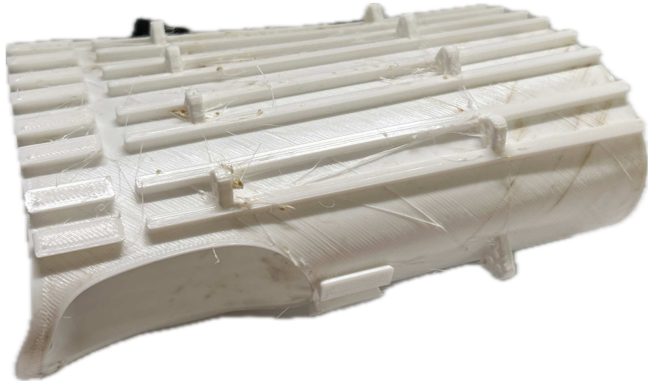
Slika 5.13. Isprintani model rukavice za prihvata mekih robota.
