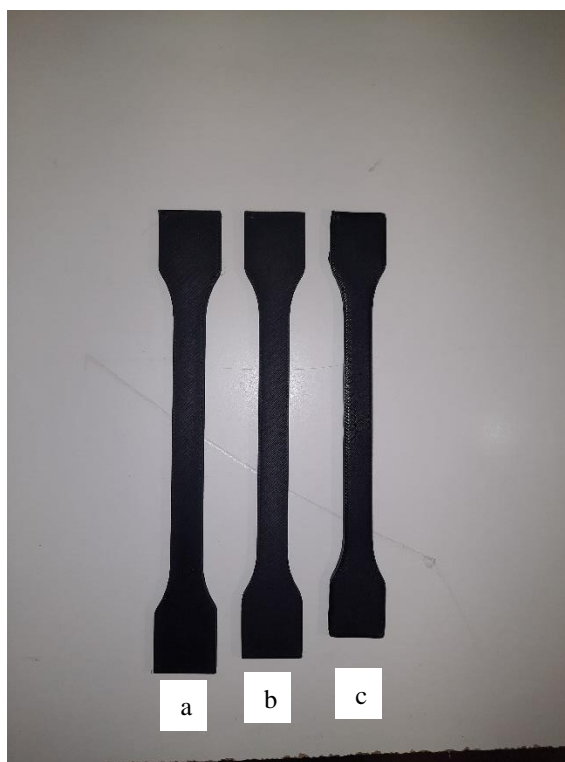
Slika 4.5. Jedna serija PLA uzoraka s (a) termički neobrađenom epruvetom, (b) epruvetom grijanom na 60 °C i (c) epruvetom grijanom na 100 °
