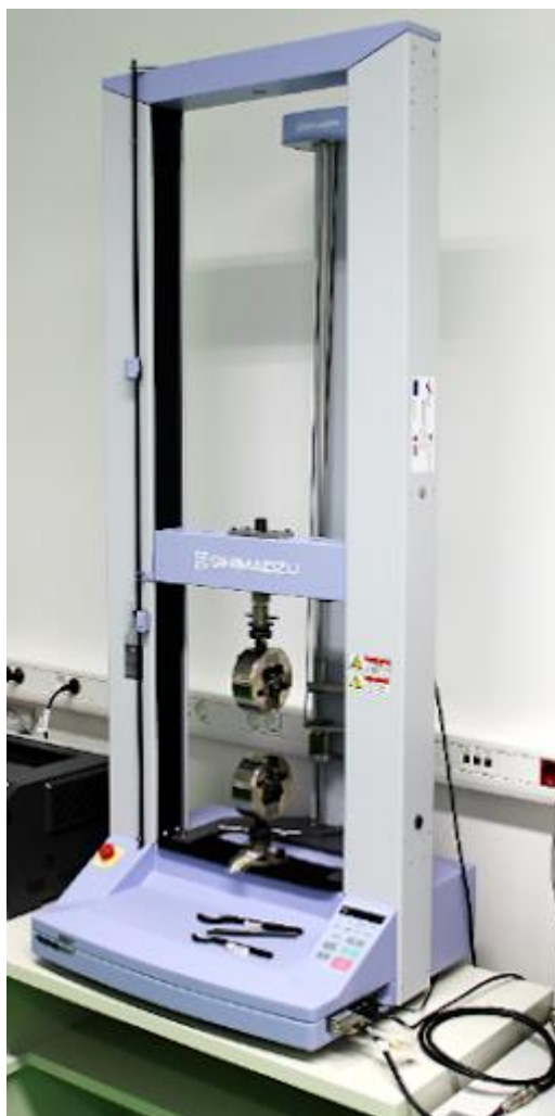
Slika 4.3. Kidalica Shimadzu autograph AGS-X (10 kN)
