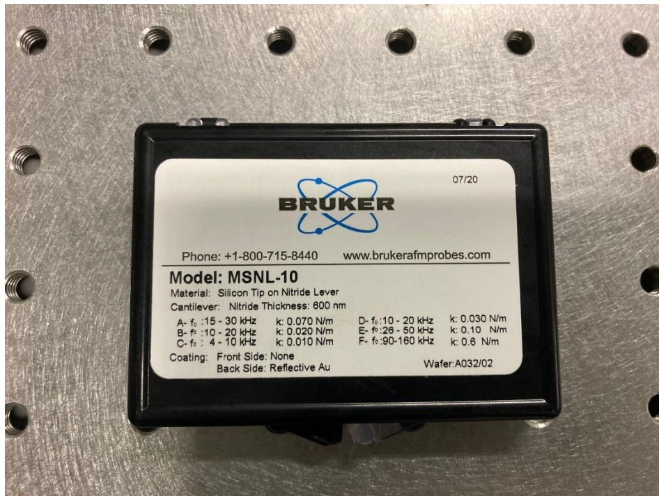
Slika 4.6: Nominalne vlastite frekvencije i krutosti MSNL-10 osjetnika dane od strane proizvođača
