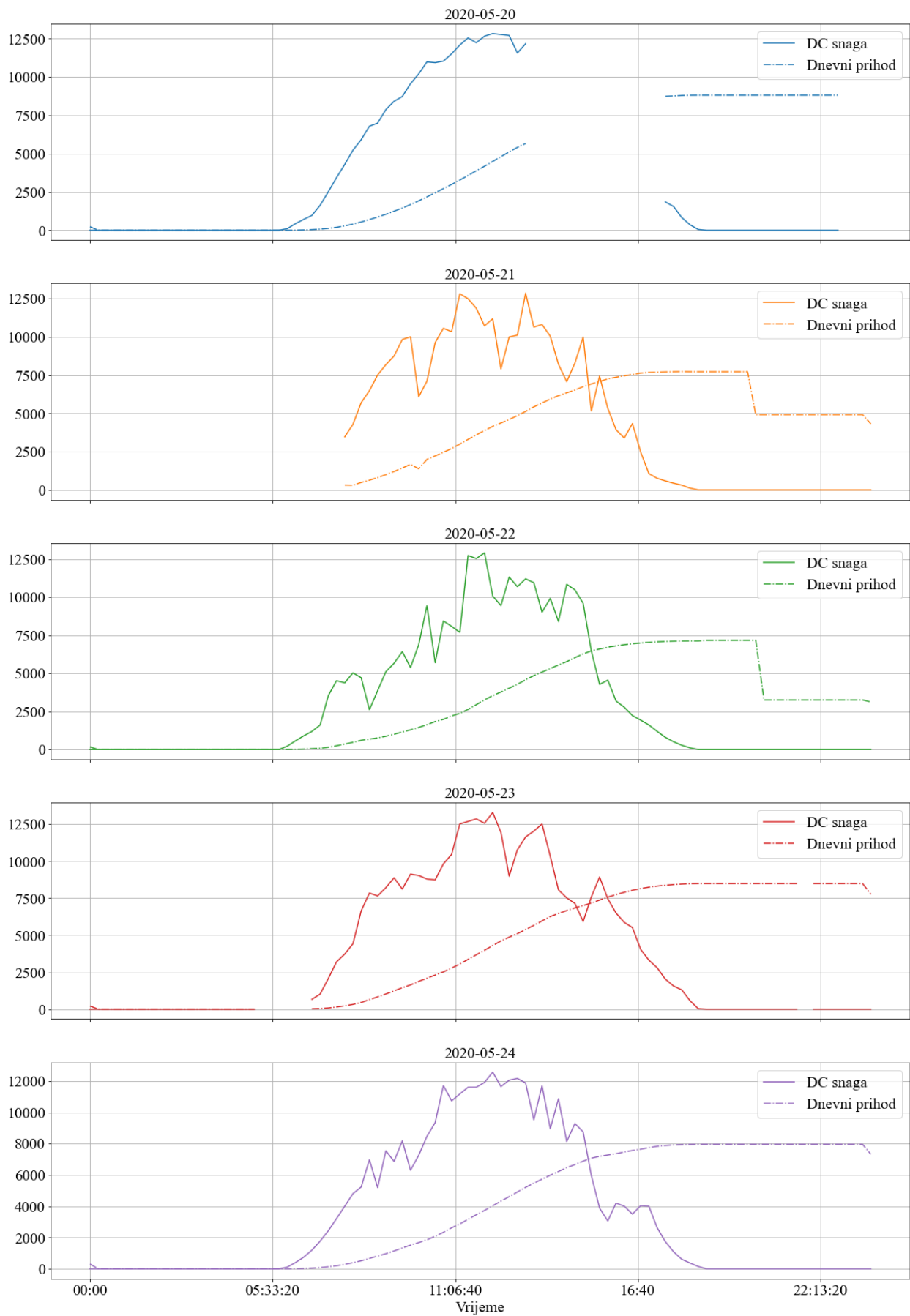
Slika 3.8. Prikaz krivulje DC snage i dnevnog prihoda za dane od 20.05.2020. do 24.05.2020.
