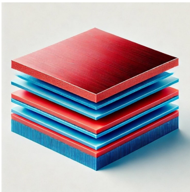
Slika 6.2. Shematski prikaz KOMP-2 (ABS – crveno, TPU – plavo)
