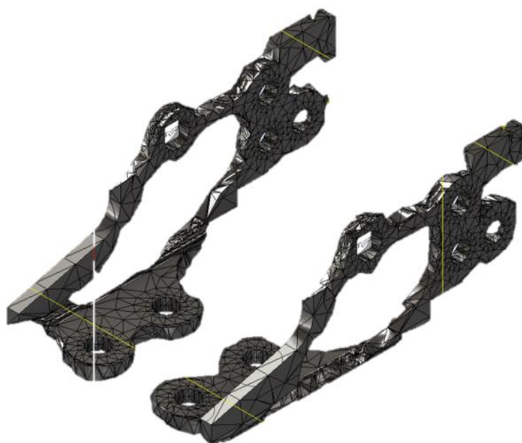
Slika 7.32 Rezultat optimizacije topologije elementa „Šarka 2“ (60% reducirana masa)
