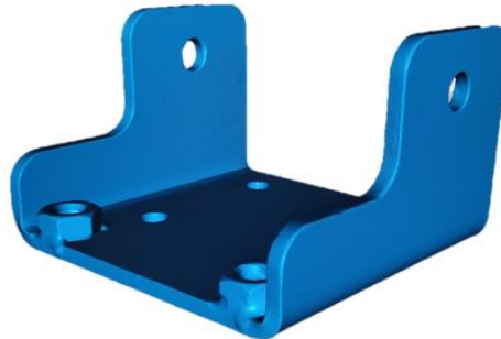
Slika 2.9 Rezultat skeniranja (sken) elementa "Šarka 1"
