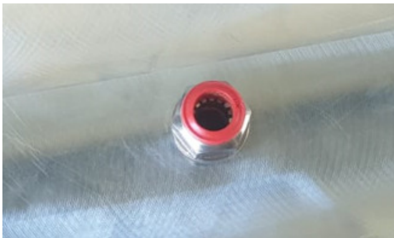
Slika 8.11. Izgled pneumatskog priključka - izvana
