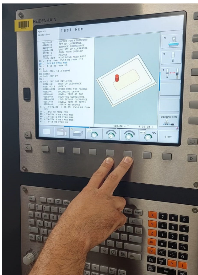
Slika 7.1. Ručno programiranje na upravljačkoj jedinici Heidenhain TNC 640
