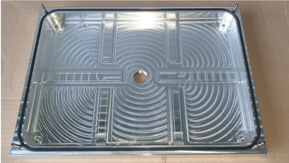
Slika 8.3. Prikaz brtve i vodilica umetnutih u poziciju 1
