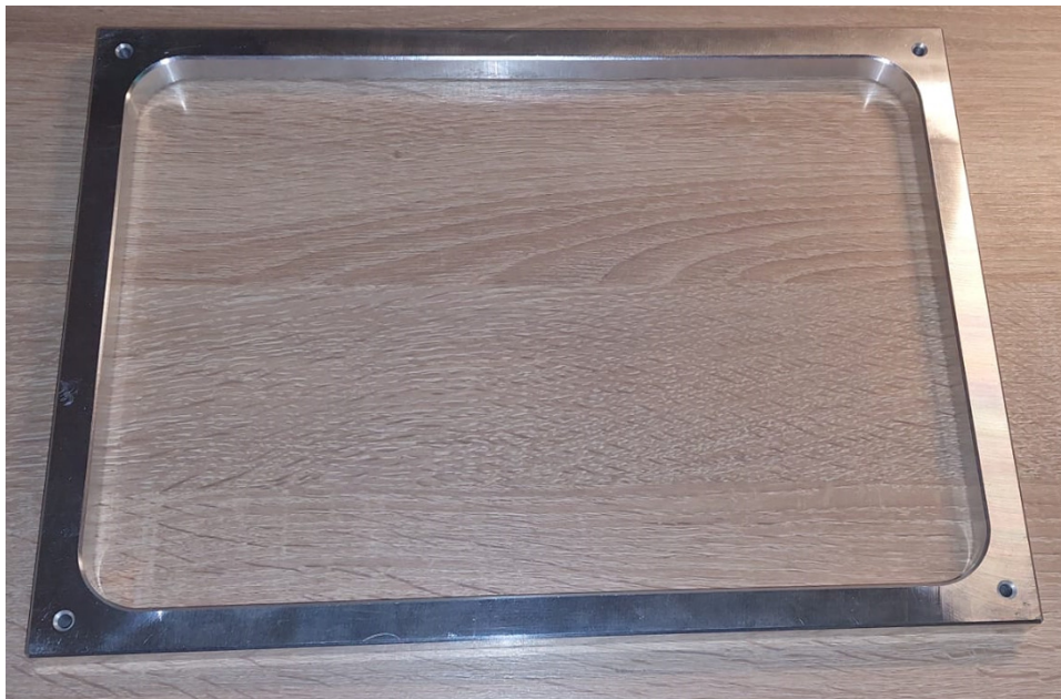
Slika 7.1.12. Finalni prikaz poklopca naprave – Pozicija 2
