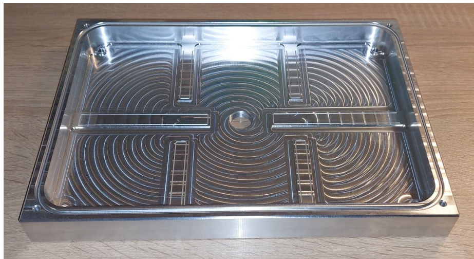
Slika 7.1.7. Finalni prikaz donjeg dijela naprave – Pozicija 1
