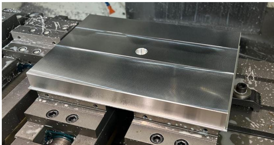
Slika 7.1.4. Izgled površine nakon operacija finog glodanja
