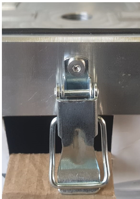
Slika 8.9. Zatvarač stranice spojen u donji dio naprave
