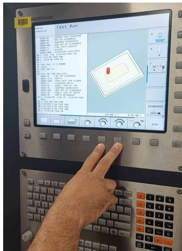
Slika 7.1. Ručno programiranje na upravljačkoj jedinici Heidenhain TNC 640
