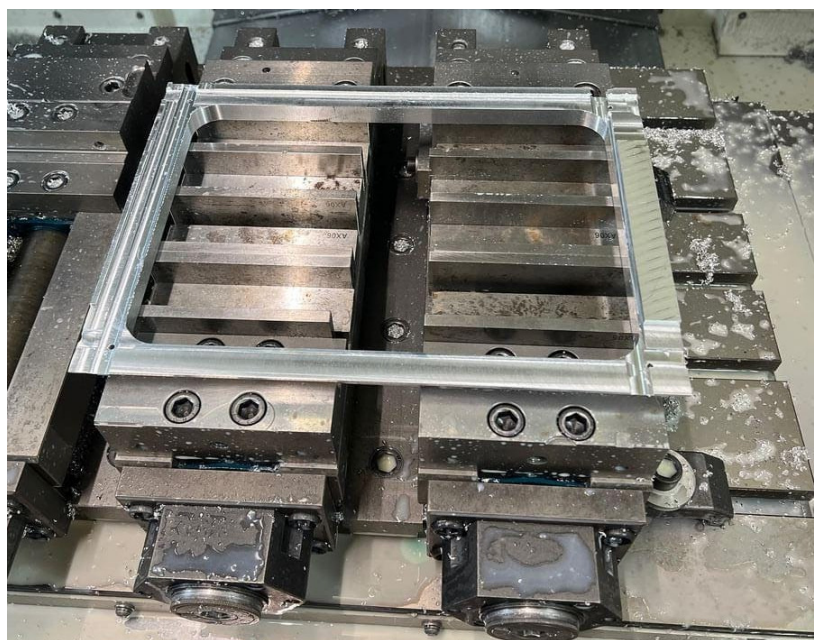
Slika 7.1.11. Prikaz drugog stezanja pozicije 2
