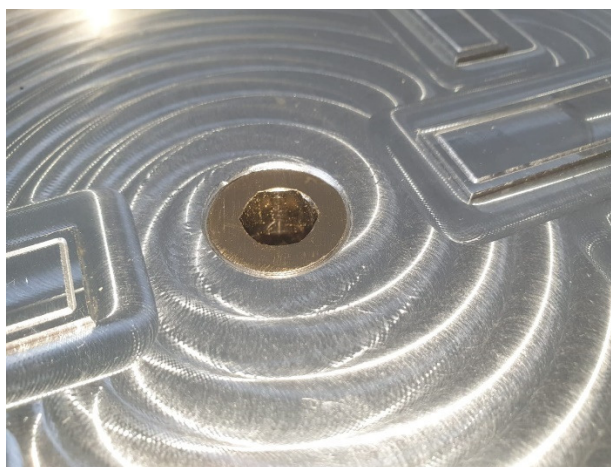
Slika 8.10. Montaža pneumatskog priključka za vakuum pumpu
