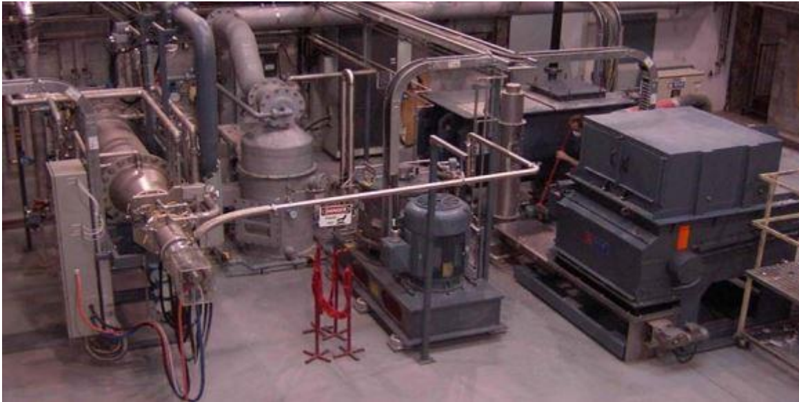
Slika 6.3.1.1 Plazma sustav za uplinjavanje
