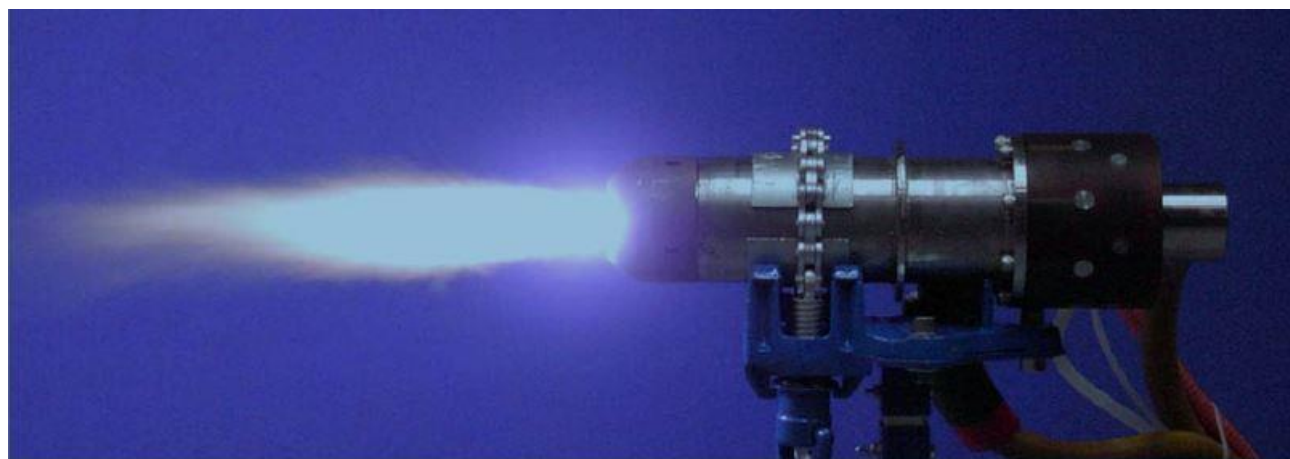
Slika 6.2.1.1 Baklja plazma sustava jačine 150 kW
