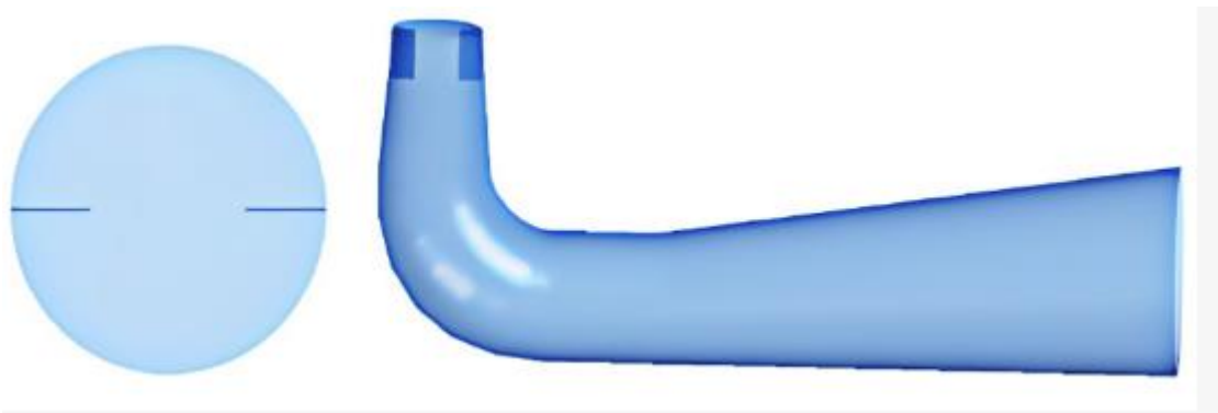
Slika 6.3 Shematski prikaz postavljene pregrade na ulazu u difuzor [20]
