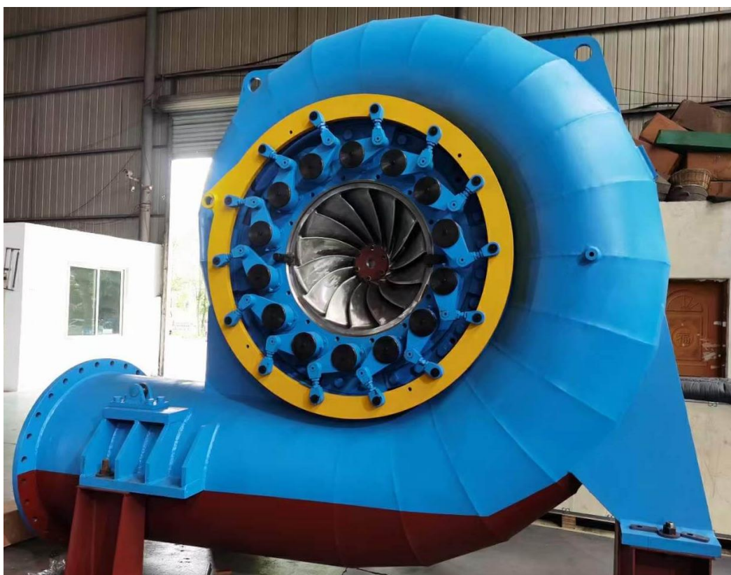
Slika 4.4. Francis-ova turbina i generator električne energije [11]
