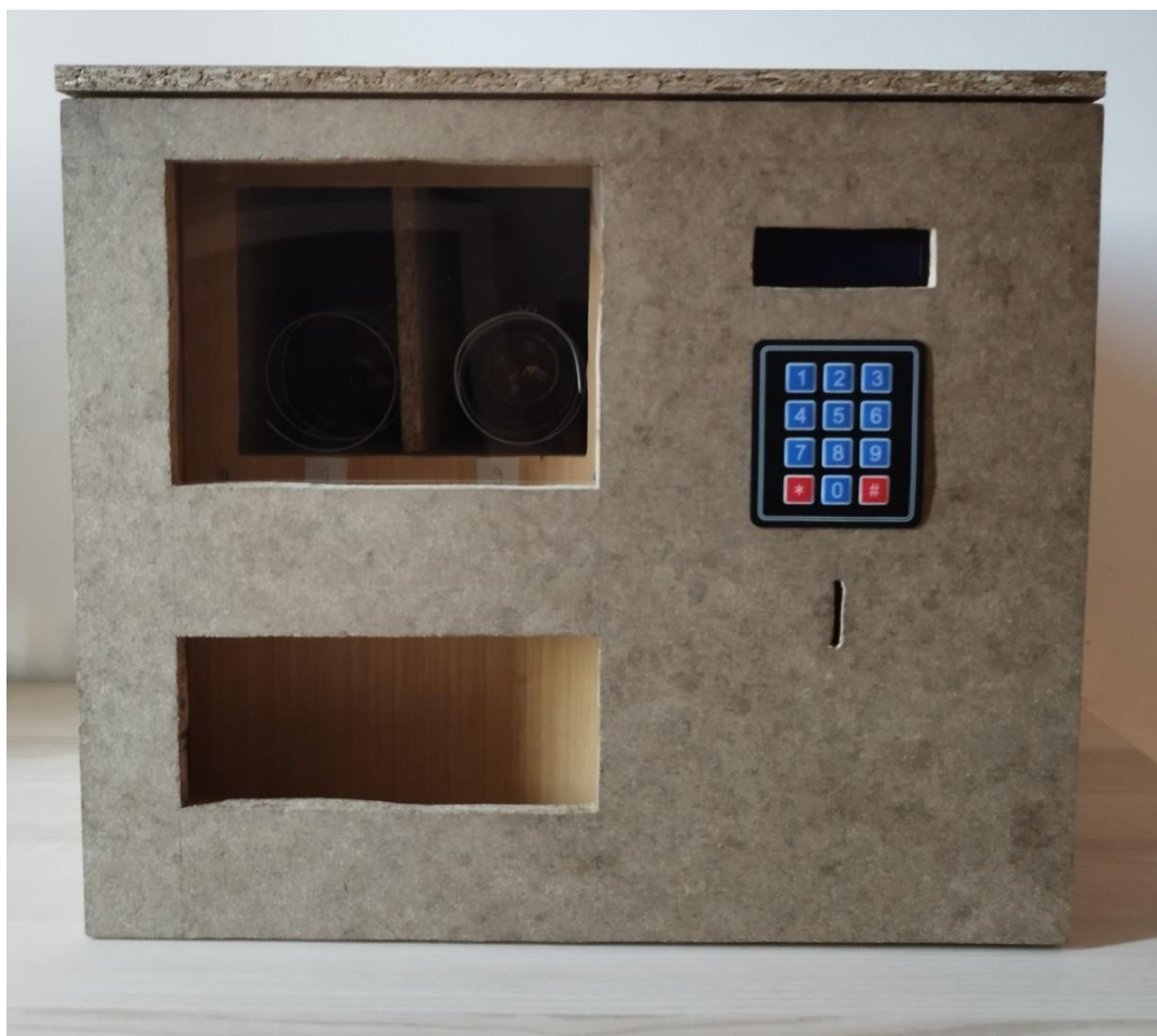
Slika 6.4. Prototip samoposlužnog automata temeljen na Arduinu
