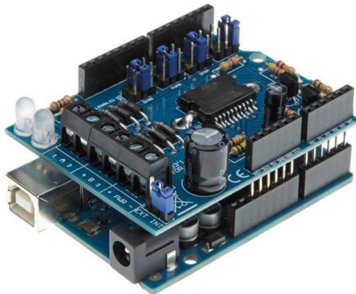
Slika 3.2. Arduino Shield povezan na Arduino
