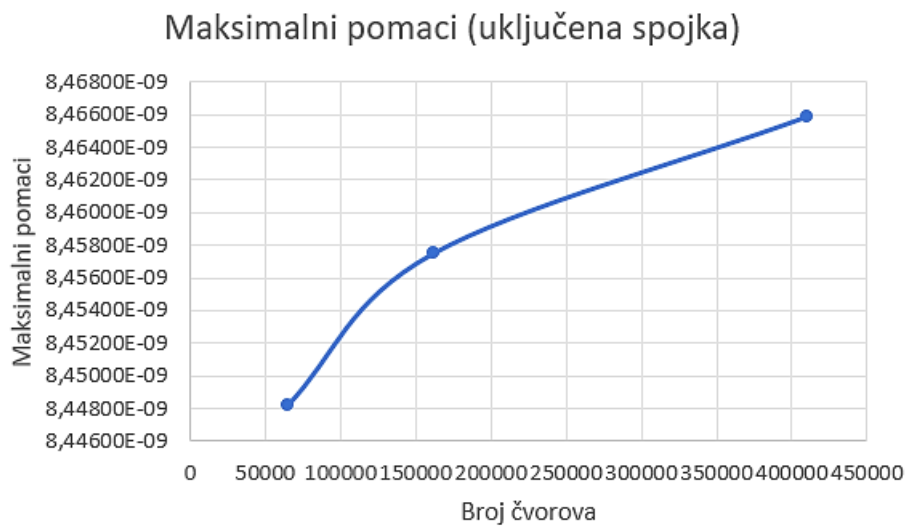
Graf 8.3. Maksimalni pomaci polužice uključene spojke
