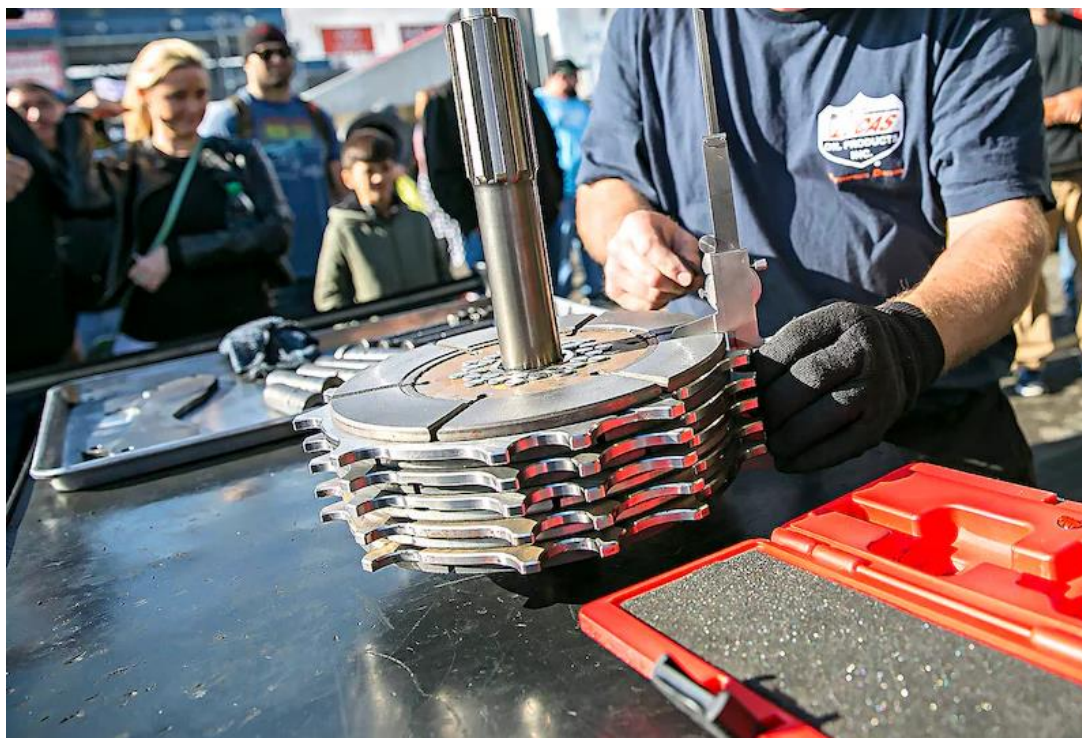
Slika 6.5. – Izgled sklopa tarnih površina spojke [12]
