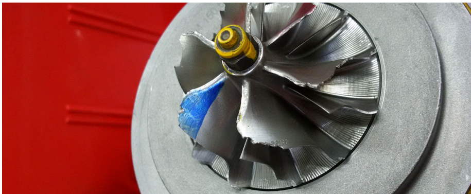
Slika 6.5. Puknuće lopatica rotora turbopuhala
