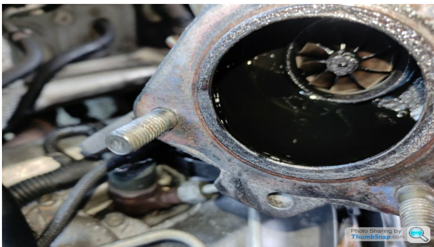
Slika 5.2. Prljavština unutar ulja
