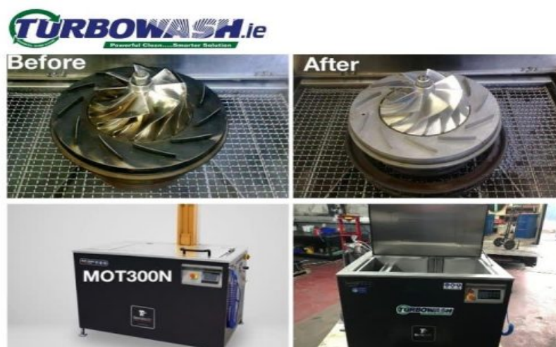
Slika 7.4. Ultrazvučno čišćenje dijelova turbopuhala.
