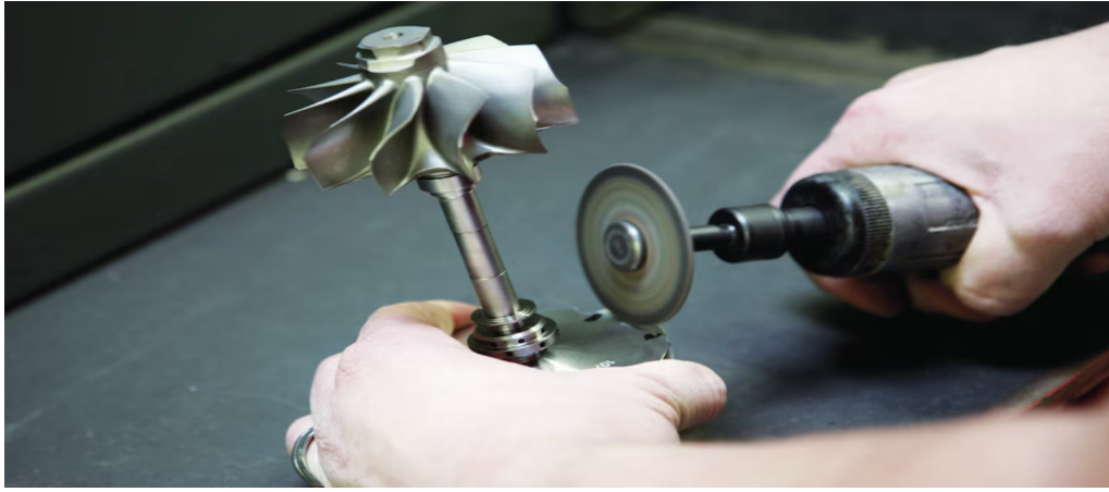
Slika 6.6. Proces čišćenja pomoću jednostavnog pneumatskog uređaja za skidanje slojeva
