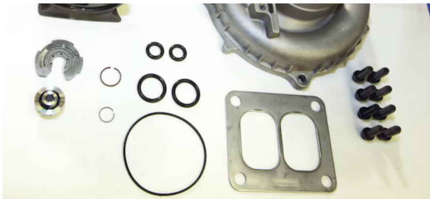
Slica 6.4. Brtva i ležaj turbopuhala
