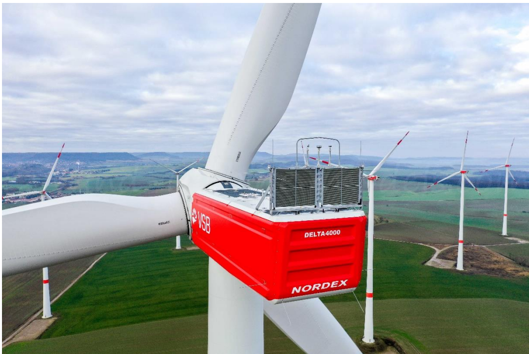
Slika 3.7. Vjetroturbina N149/4.0-4.5 u sklopu vjetroelektrane u Njemačkoj [17]
