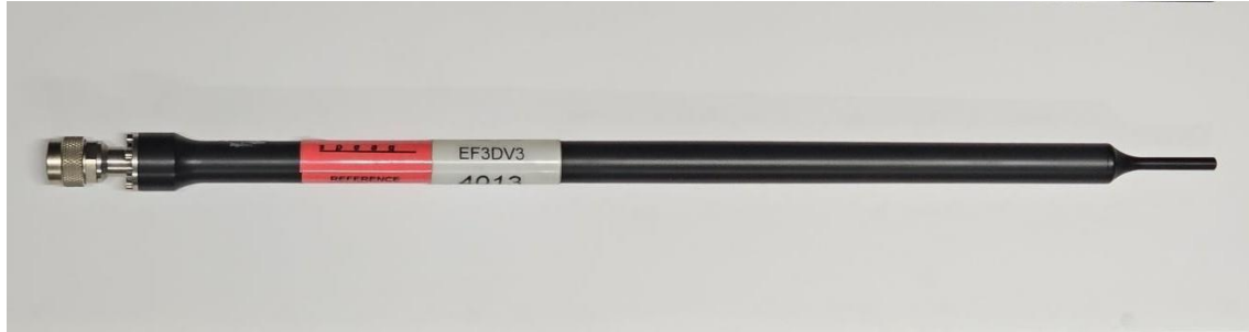
Slika 3.2.4 EF sonda u kućištu
