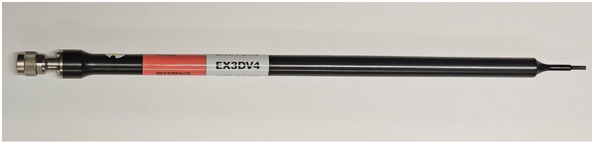
Slika 3.2.5 EX3DV4 sonda u kućištu
