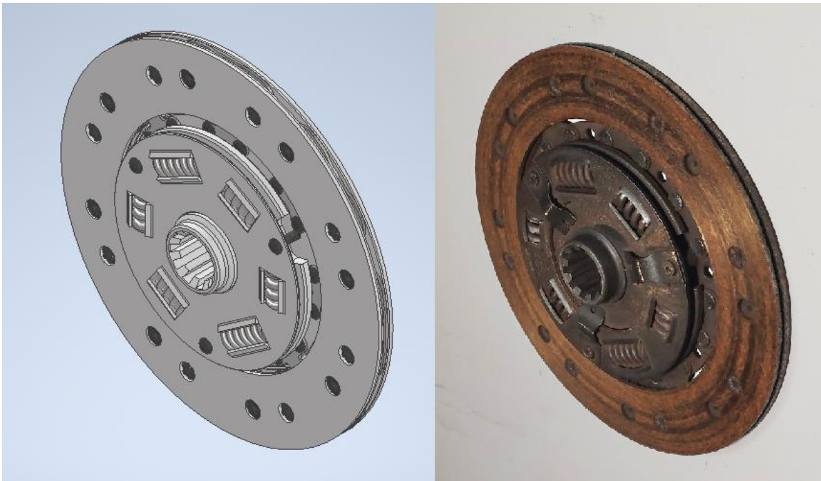
Slika 3.11: Usporedba prednje strane redizajnirane lamele sa postojećom
