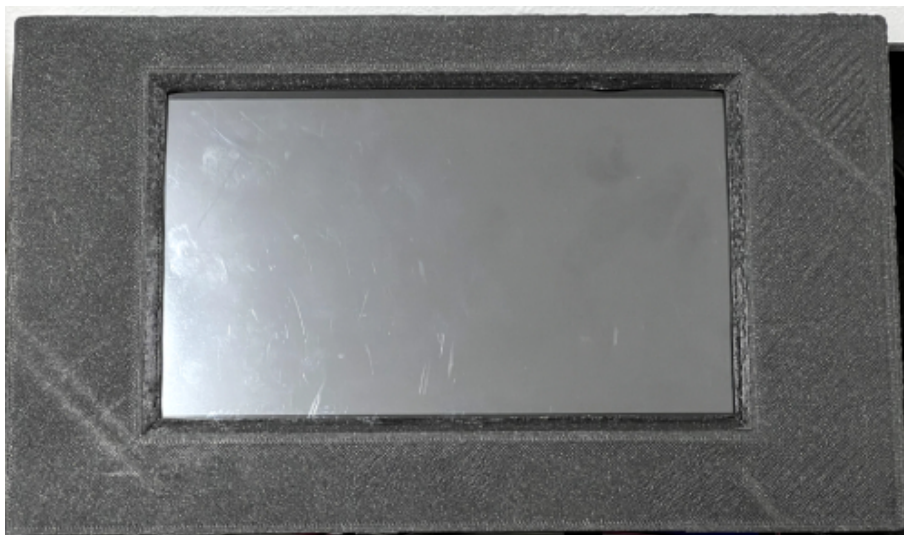
Slika 2.10 Ekran osjetljiv na dodir u 3D ispisanom kućištu
