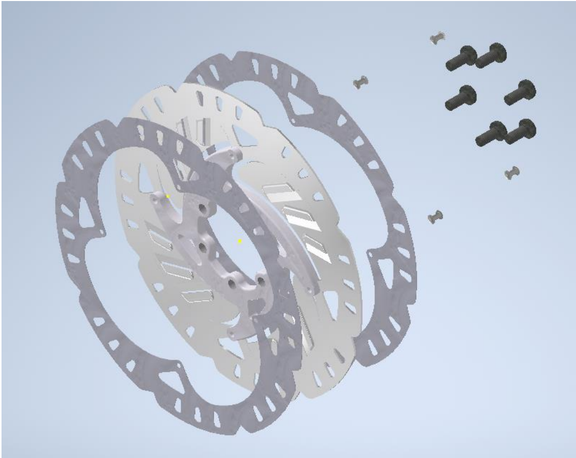
Slika 4.19. Trodijelna građa tarne plohe diska
