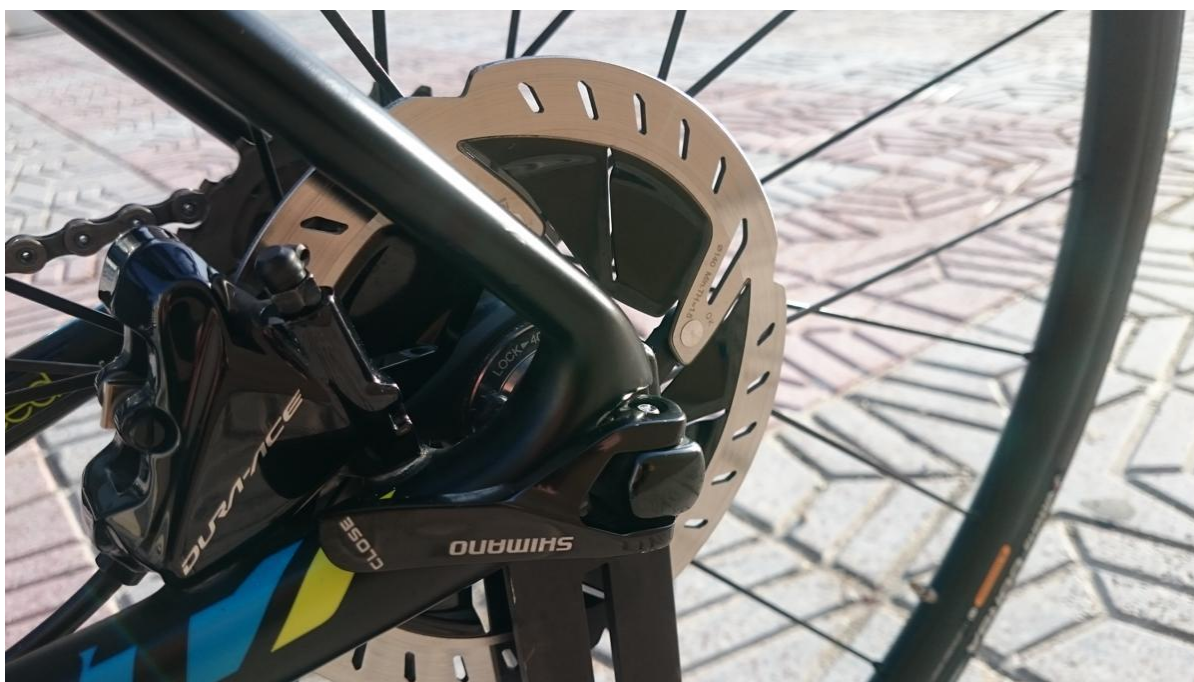
Slika 5.1. Stražnja hidraulička disk kočnica cestovnog bicikla [23]
