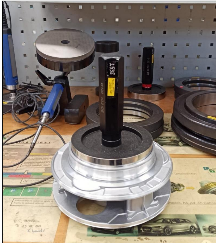
Slika 3.5. Jednostrani mjerni trn u tvrtki LTH Metal Cast
