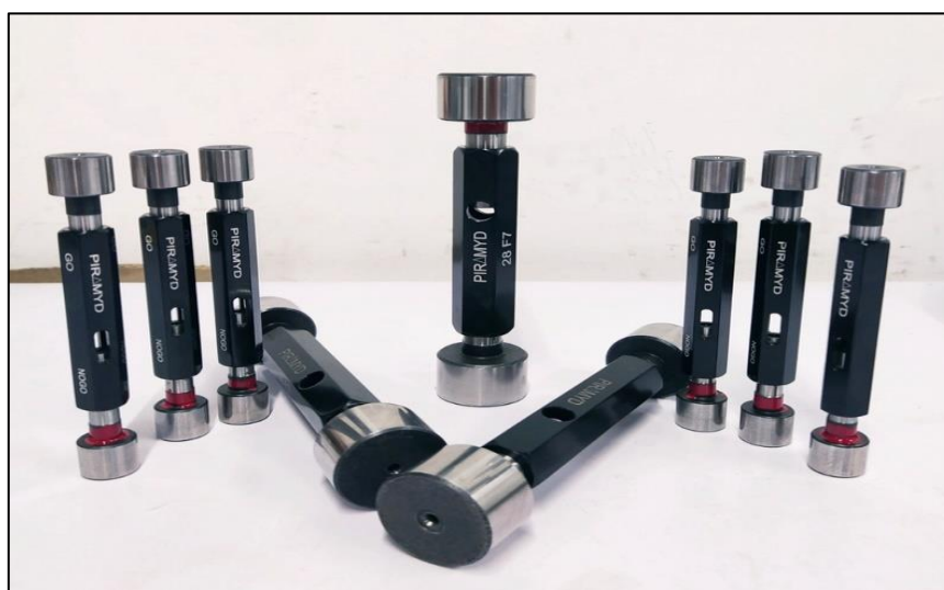
Slika 3.4. Komplet mjernih trnova različitih nazivnih mjera [19]
