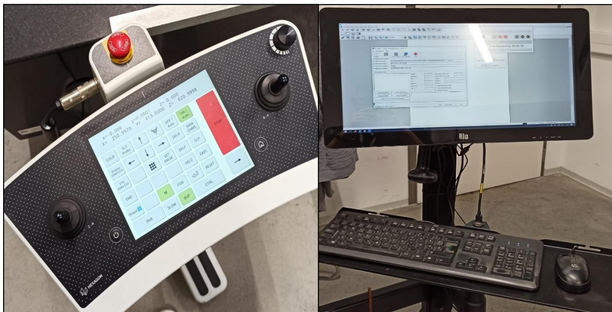
Slika 4.5. Upravljač i računalo povezani s koordinatnim mjernim uređajem
