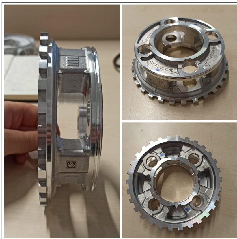
Slika 4.1. Planetarni nosač izrađen u LTH Metal Cast
