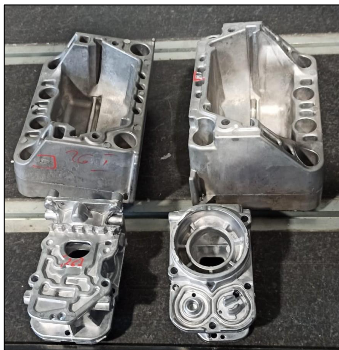
Slika 2.9. Odljevci automobilskih dijelova Al-Si legure
