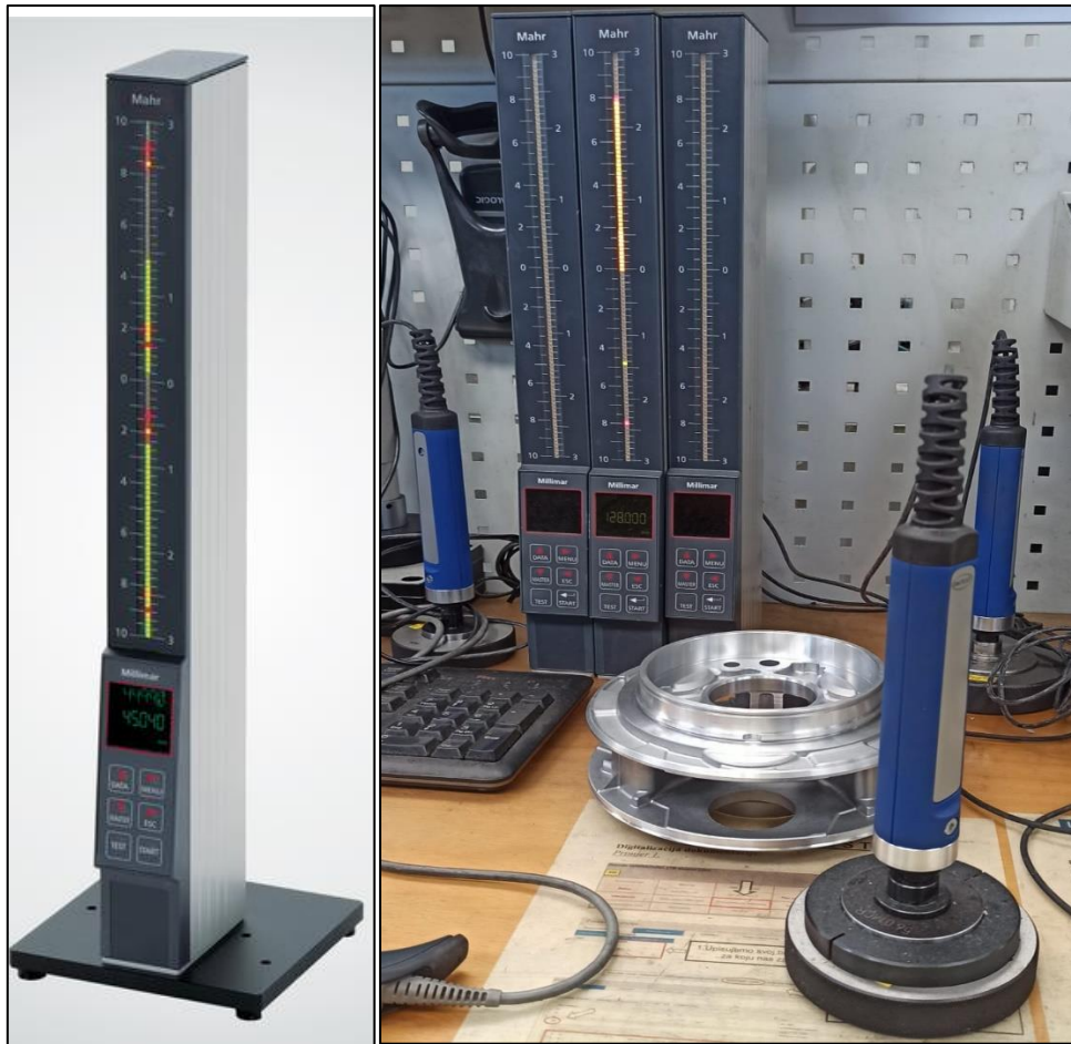
Slika 3.6. Induktivni mjerni trnovi spojeni na uređaj Millimar S 1840
