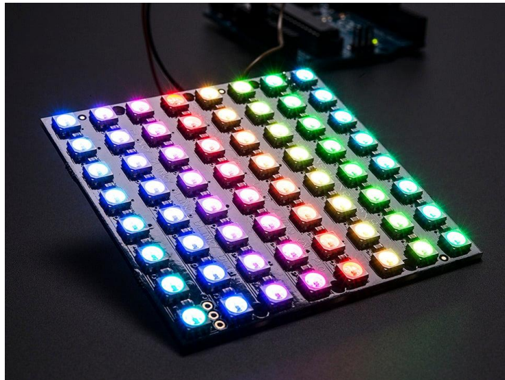
Slika 5.1. Adafruit NeoPixel modul WS2812B-64.
