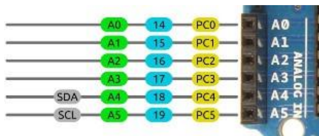
Slika 2.3. Analogni pinovi Arduino Uno razvojne pločice.
