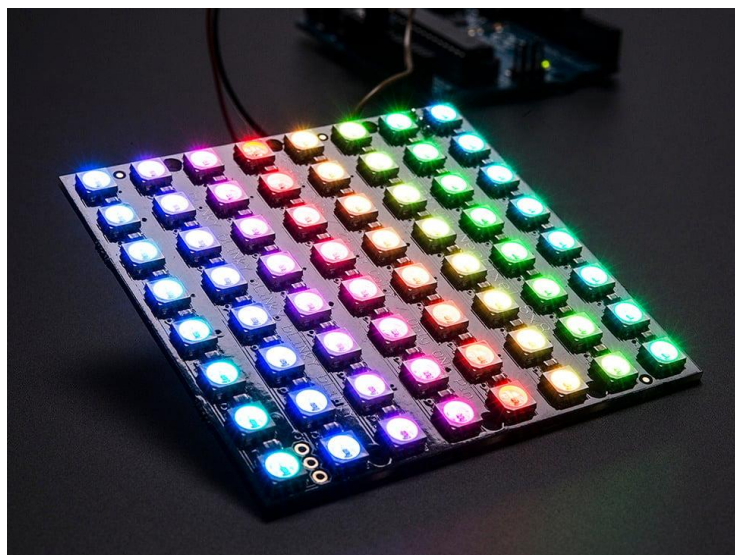
Slika 5.1. Adafruit NeoPixel modul WS2812B-64.
