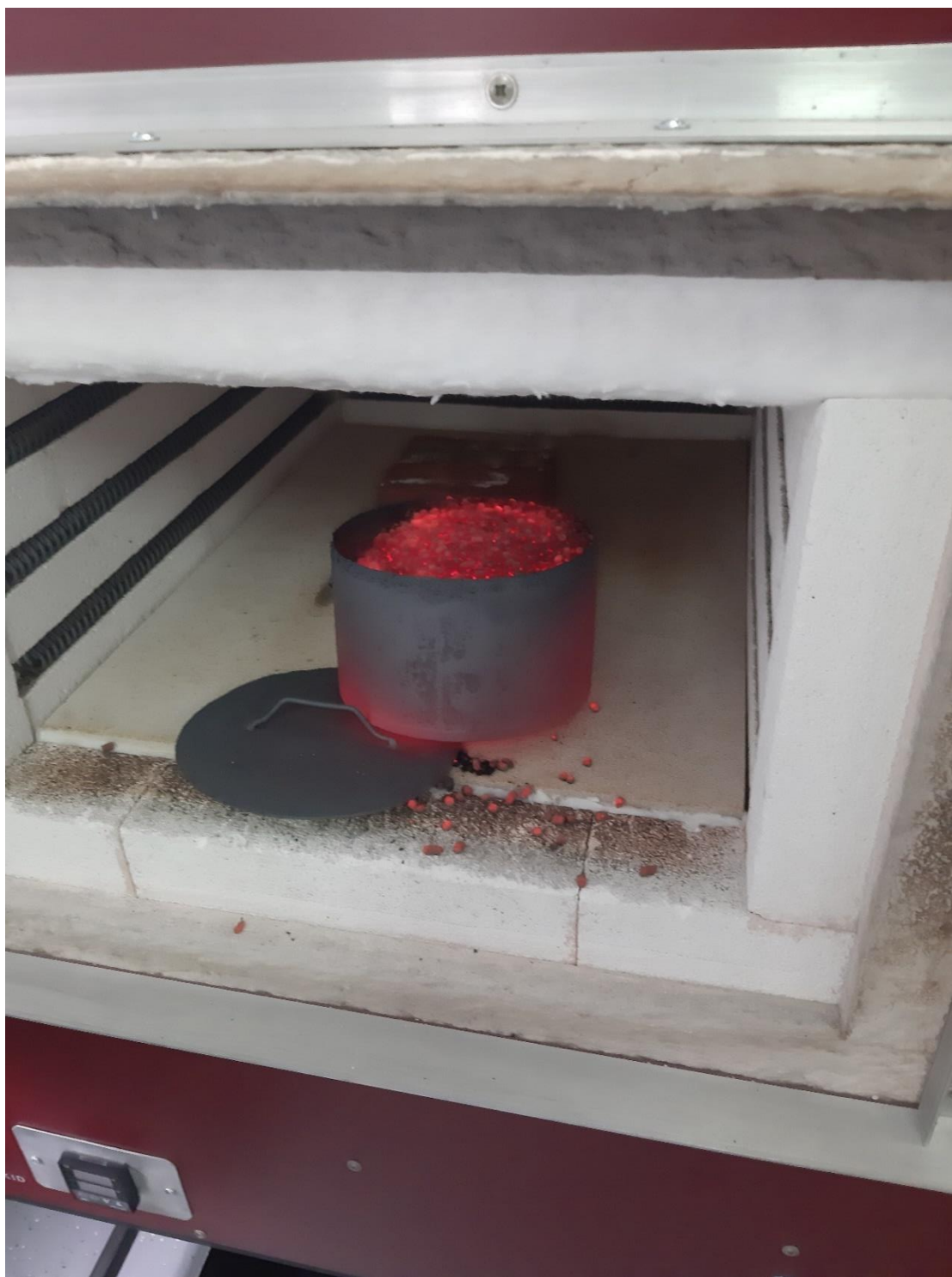
Slika 7.6. Posuda sa obratkom nakon pougljičavanja
