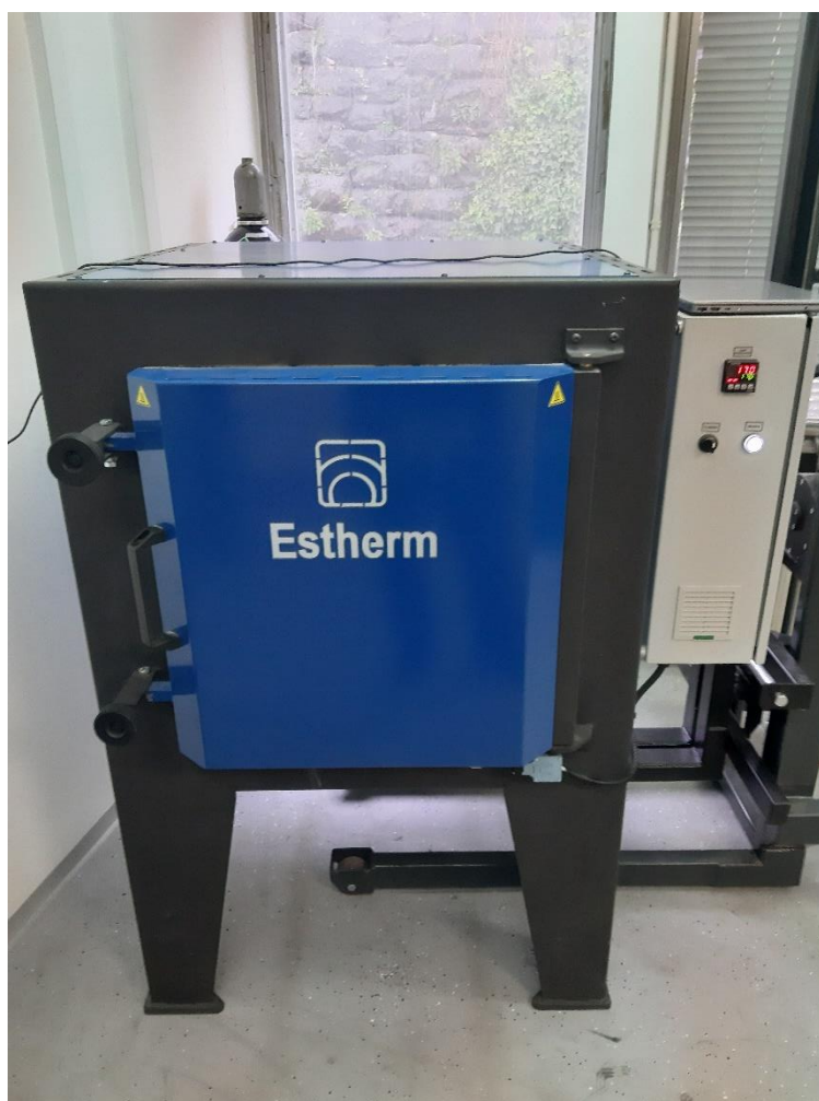
Slika 7.9. Peć za niskotemperaturno popuštanje
