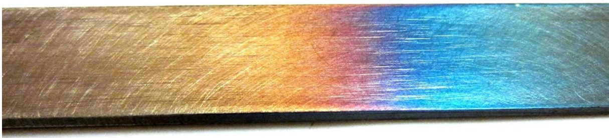
Slika 3.3. Kaljeni čelik nakon popuštanja [10]
