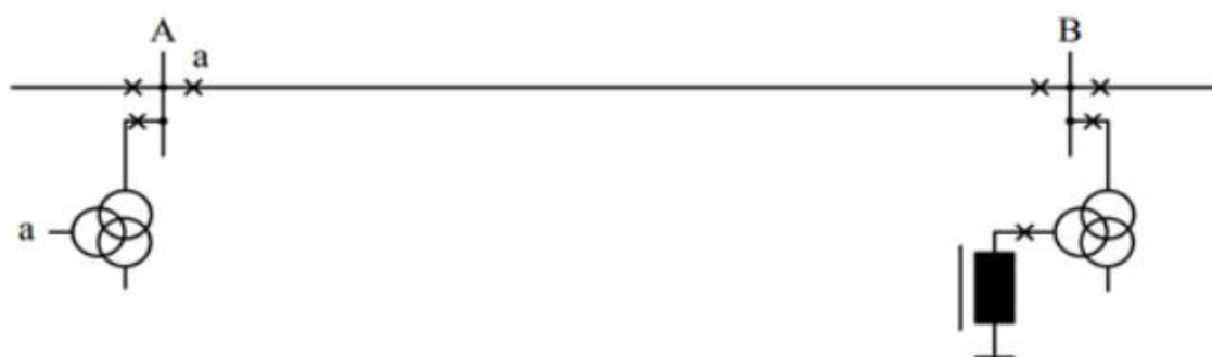
Slika 5.4. Shema spoja prigušnice na tercijar transformatora [5]
