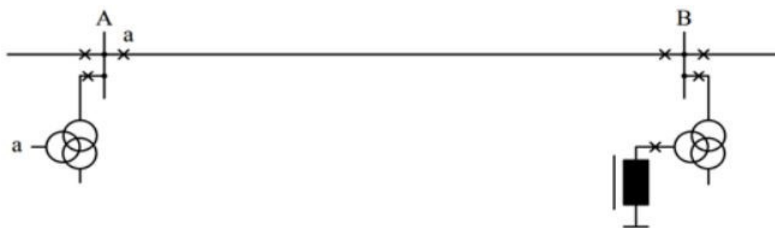
Slika 5.4. Shema spoja prigušnice na tercijar transformatora [5]
