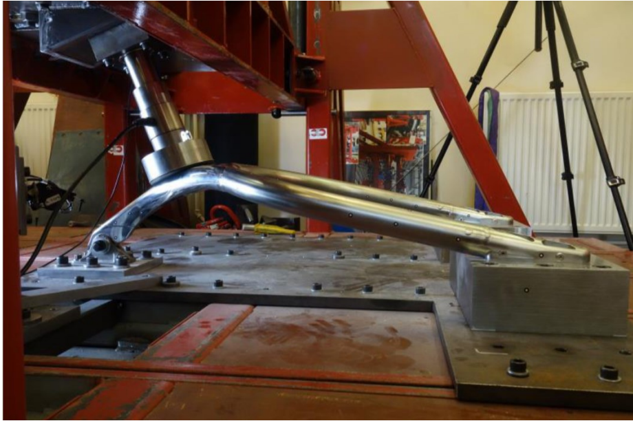
Slika 3.4 Provedba kvazistatičkog testa 1 [11]
