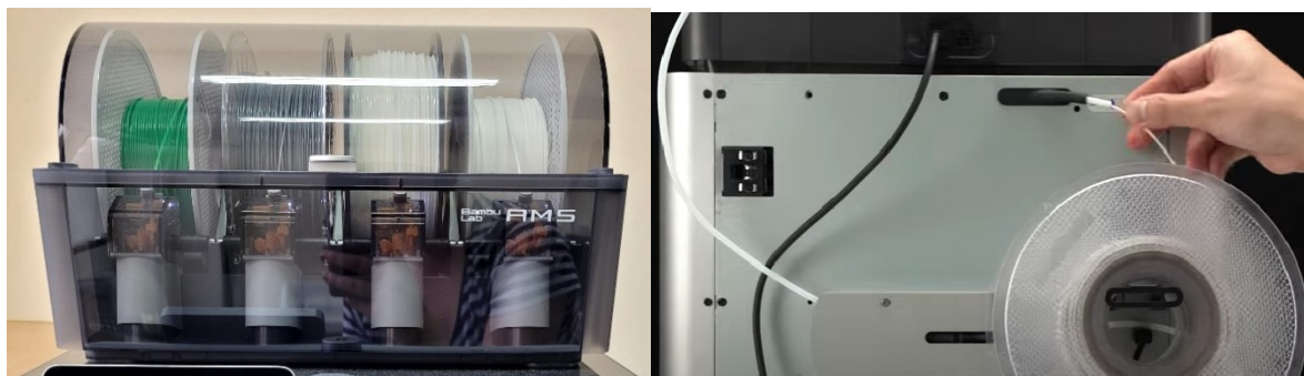
Slika 3.13 AMS (lijevo) i vanjski držač filameta (desno) Bambu Lab X1 Carbon pisača [19]
