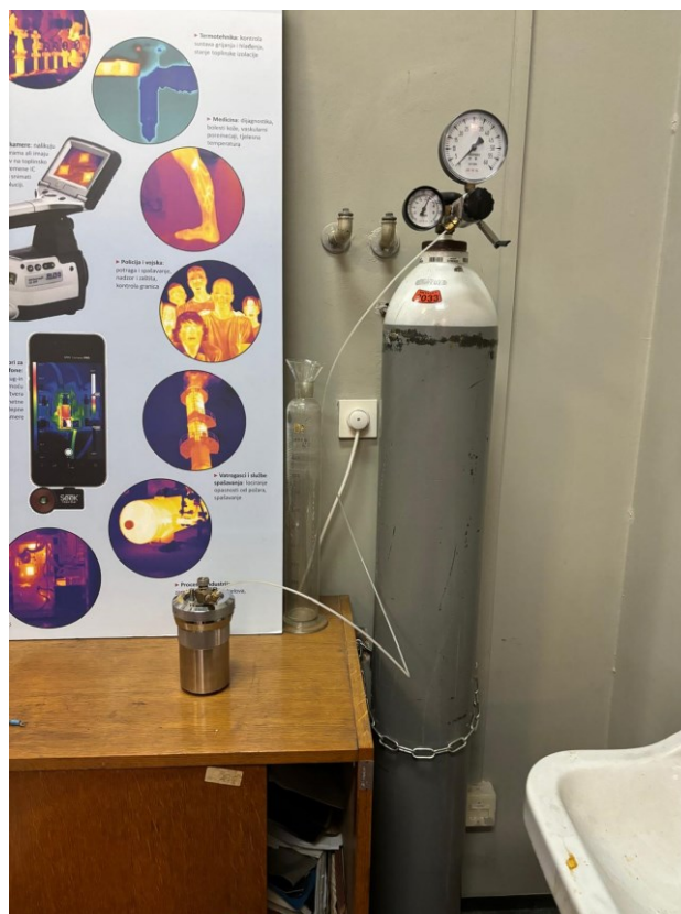
Slika 8 Prikaz punjenja kalorimetrijske bombe kisikom
