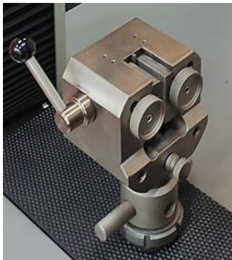
Slika 4.2. Nepomična čeljust kidalice
