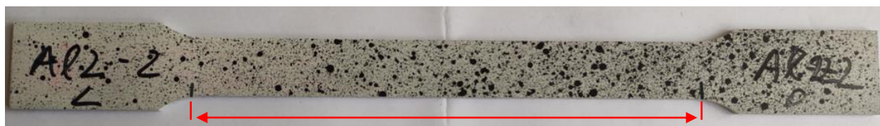
Slika 5.4. Primjer označene izvorne mjerne duljine
