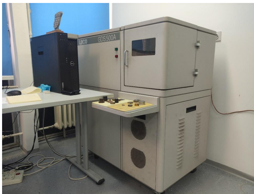
Slika 4.7. LECO GDS500A spektrometar
