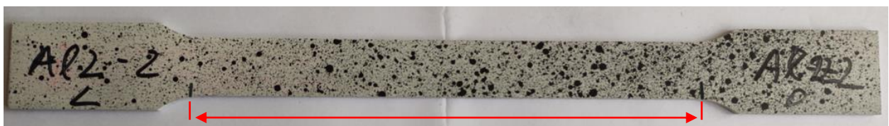
Slika 5.4. Primjer označene izvorne mjerne duljine
