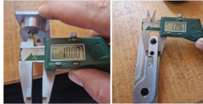
Slika 6.15. Provjeravanje točnosti izrade operacije 10
