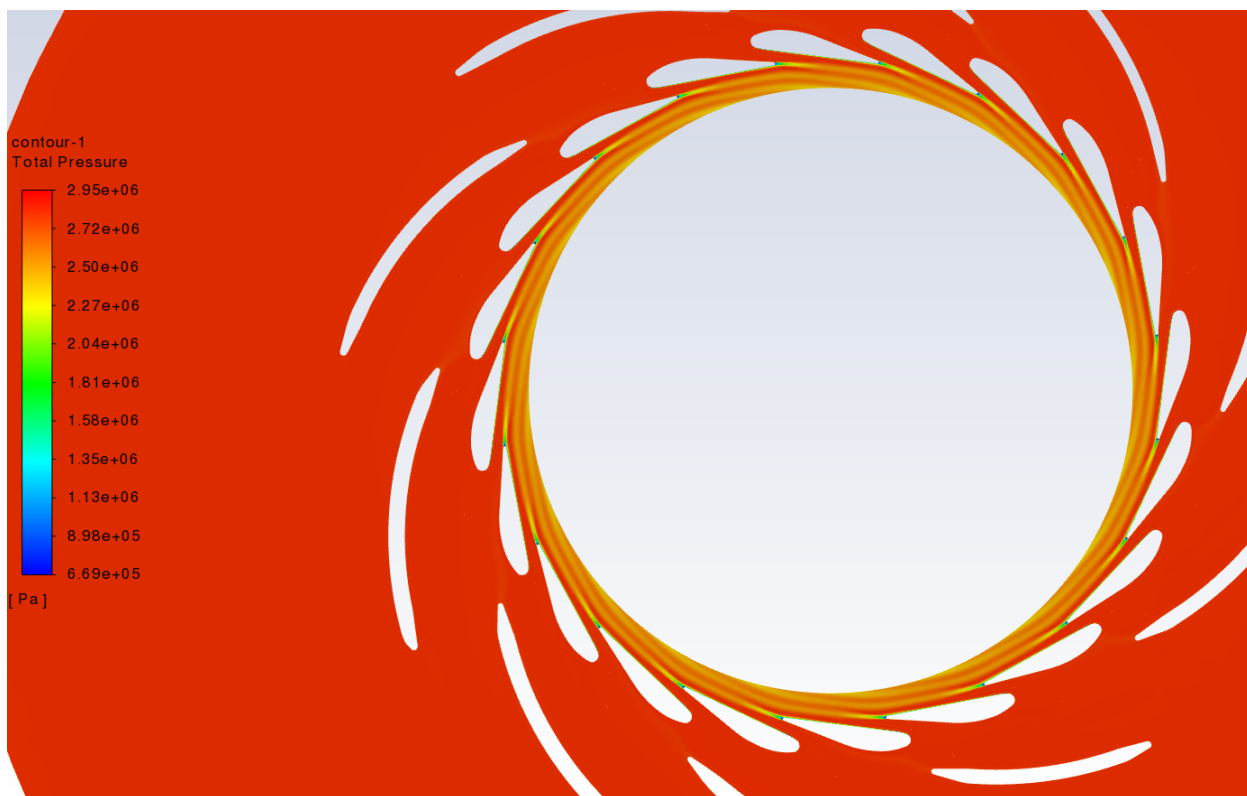
Slika 6-13 Konture totalnog tlaka u iso ravnini
