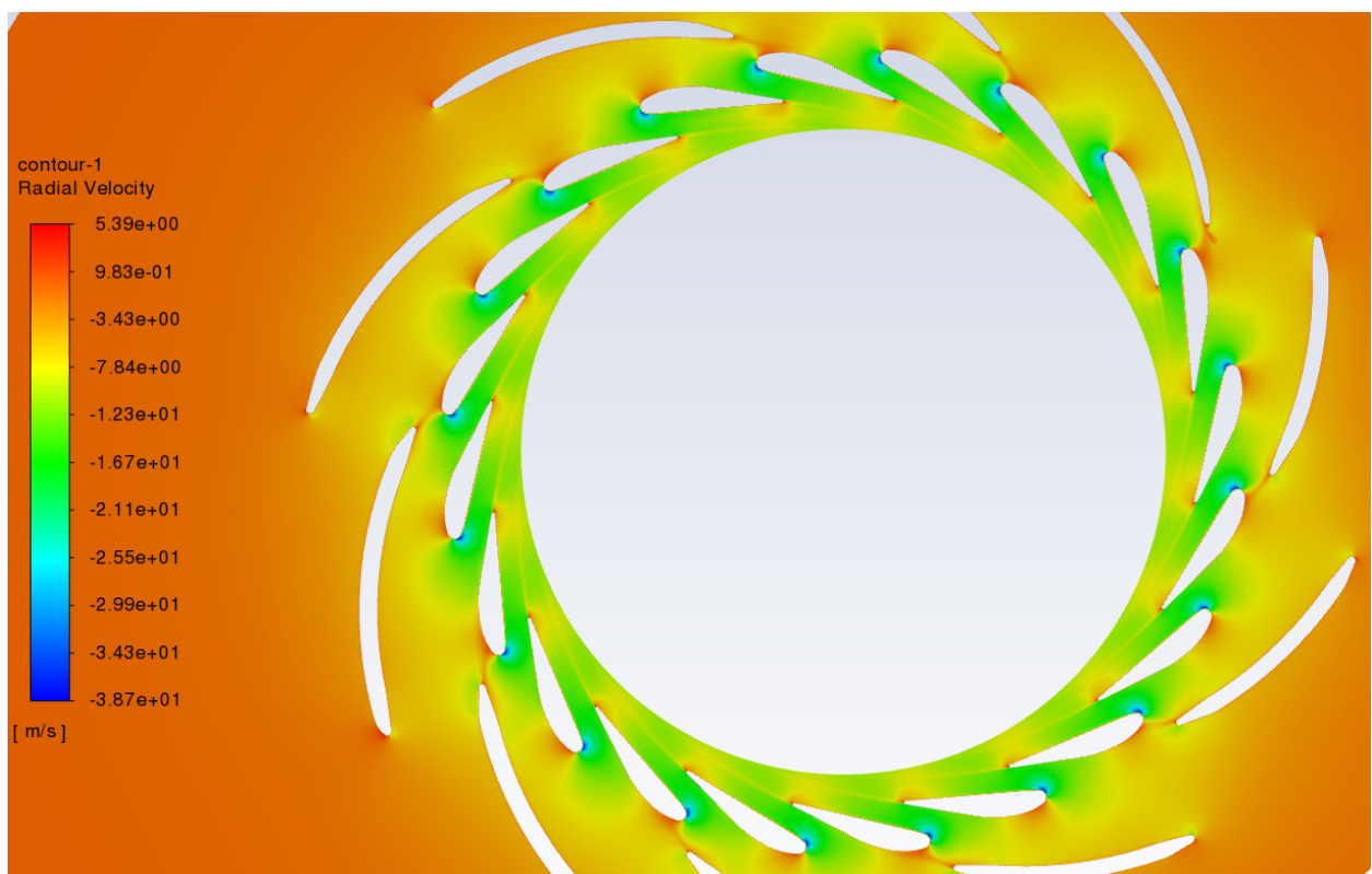
Slika 6-36 Konture radijalne brzine u iso ravnini
