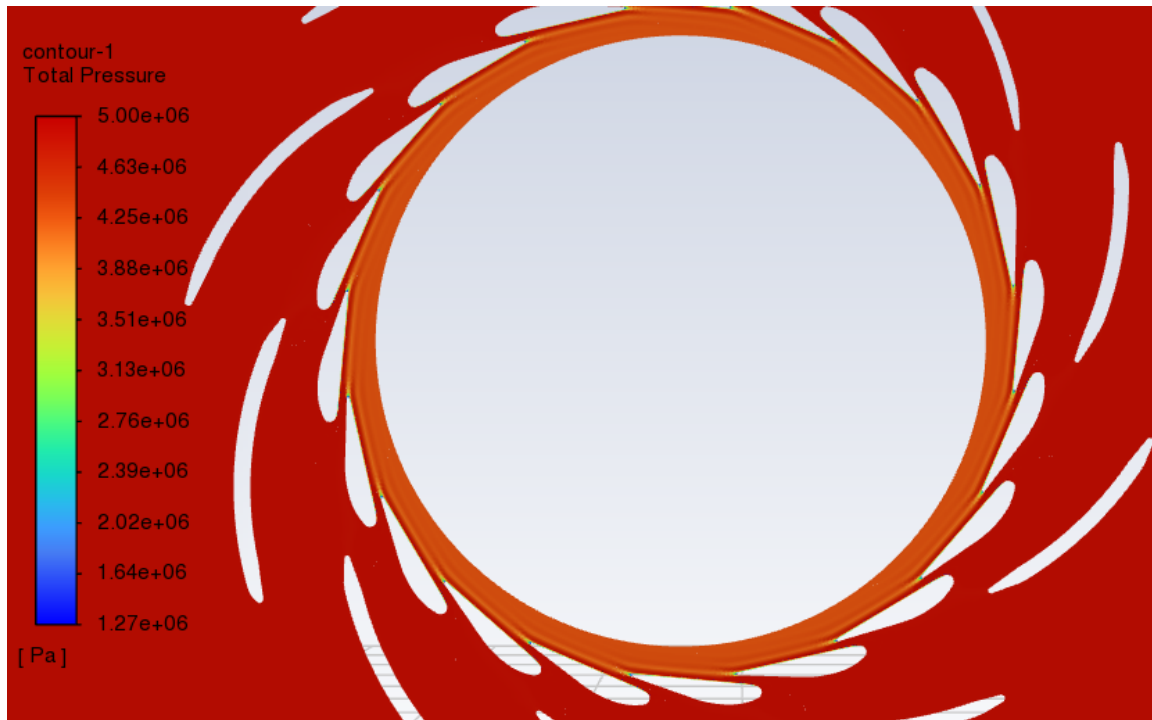
Slika 6-6 Konture totalnog tlaka u iso ravnini
