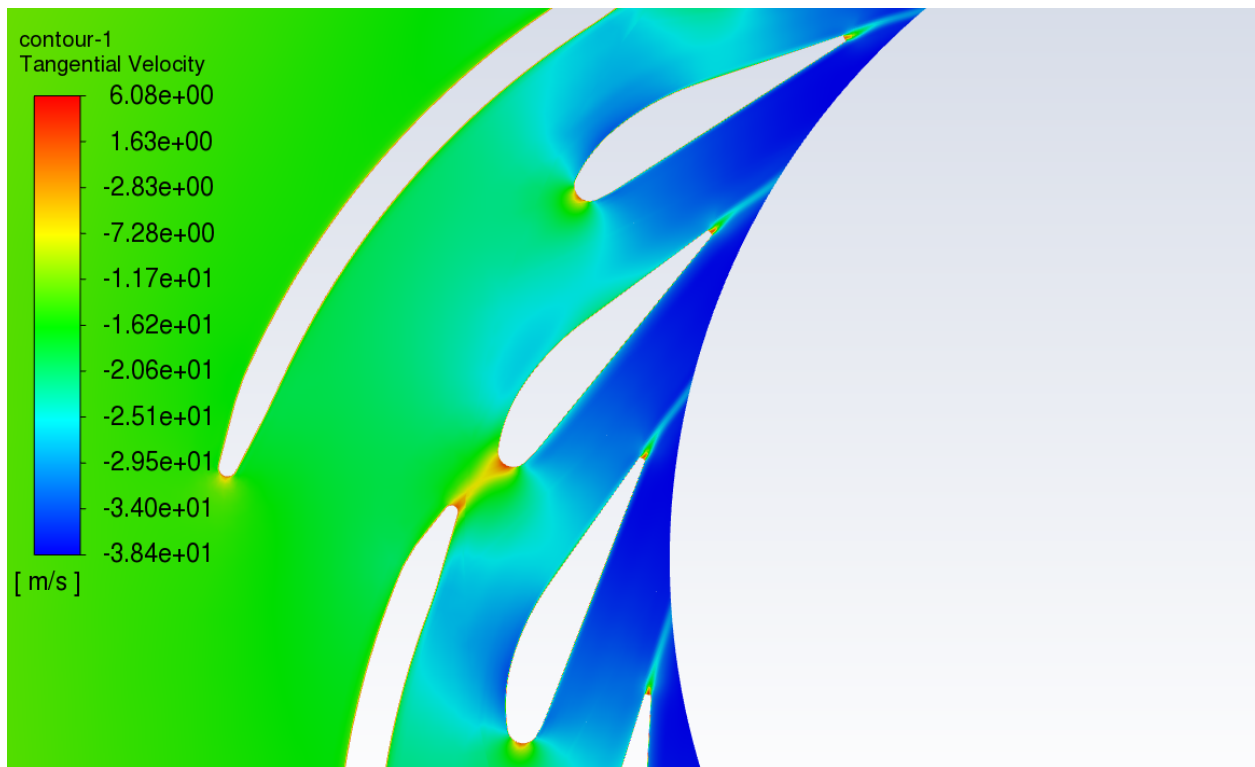
Slika 6-72 Konture tangencijalne brzine u iso ravnini
