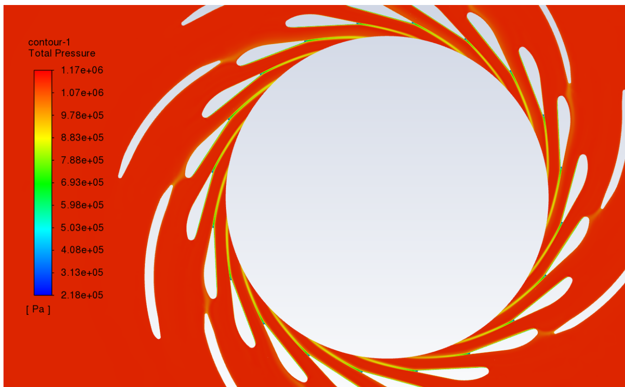
Slika 6-48 Konture totalnog tlaka u iso ravnini
