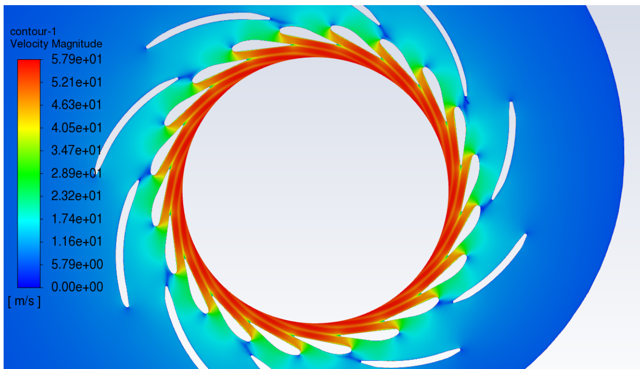
Slika 6-26 Konture magnitude brzine u iso ravnini
