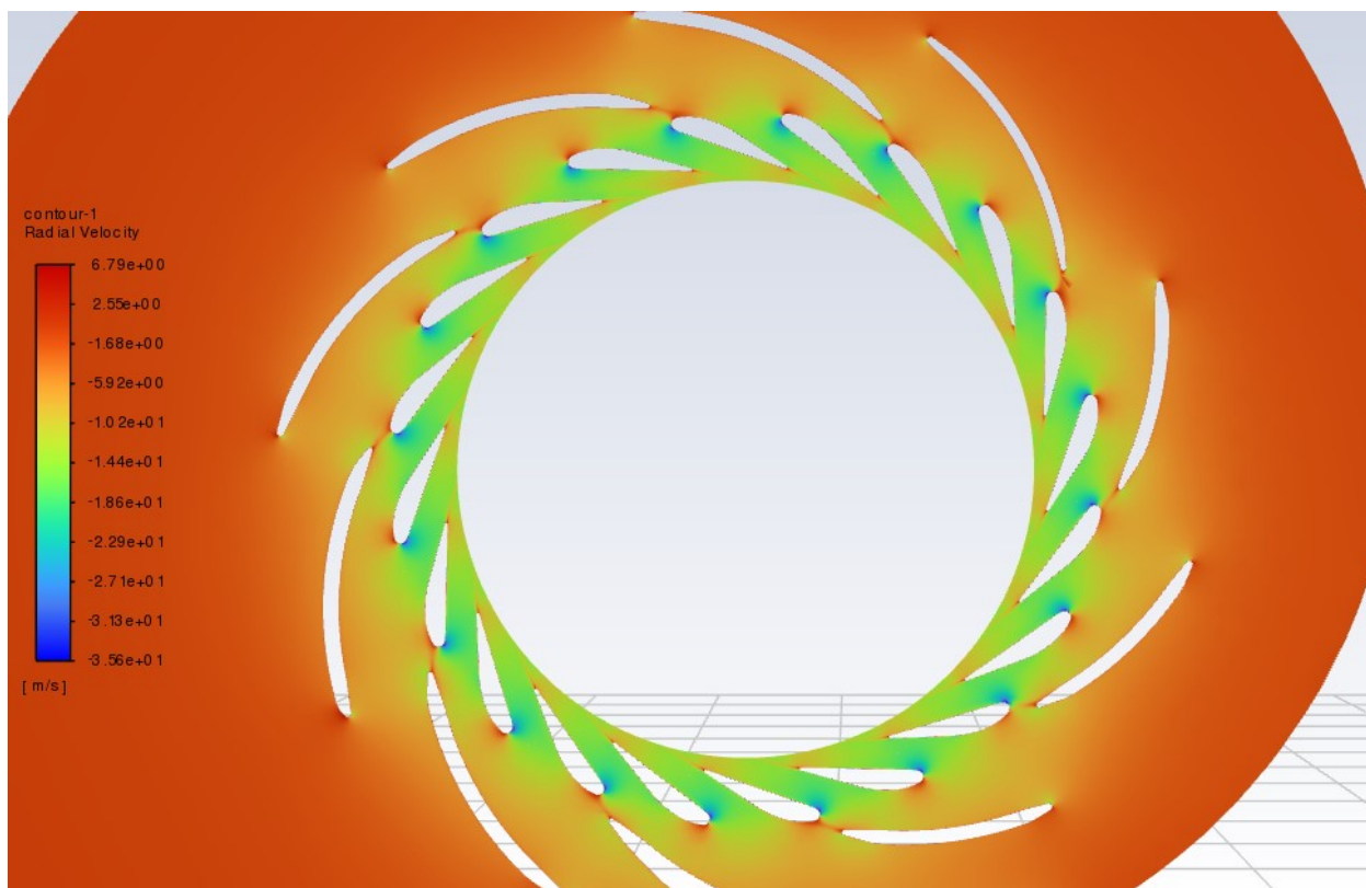
Slika 6-63 Konture radijalne brzine u iso ravnini
