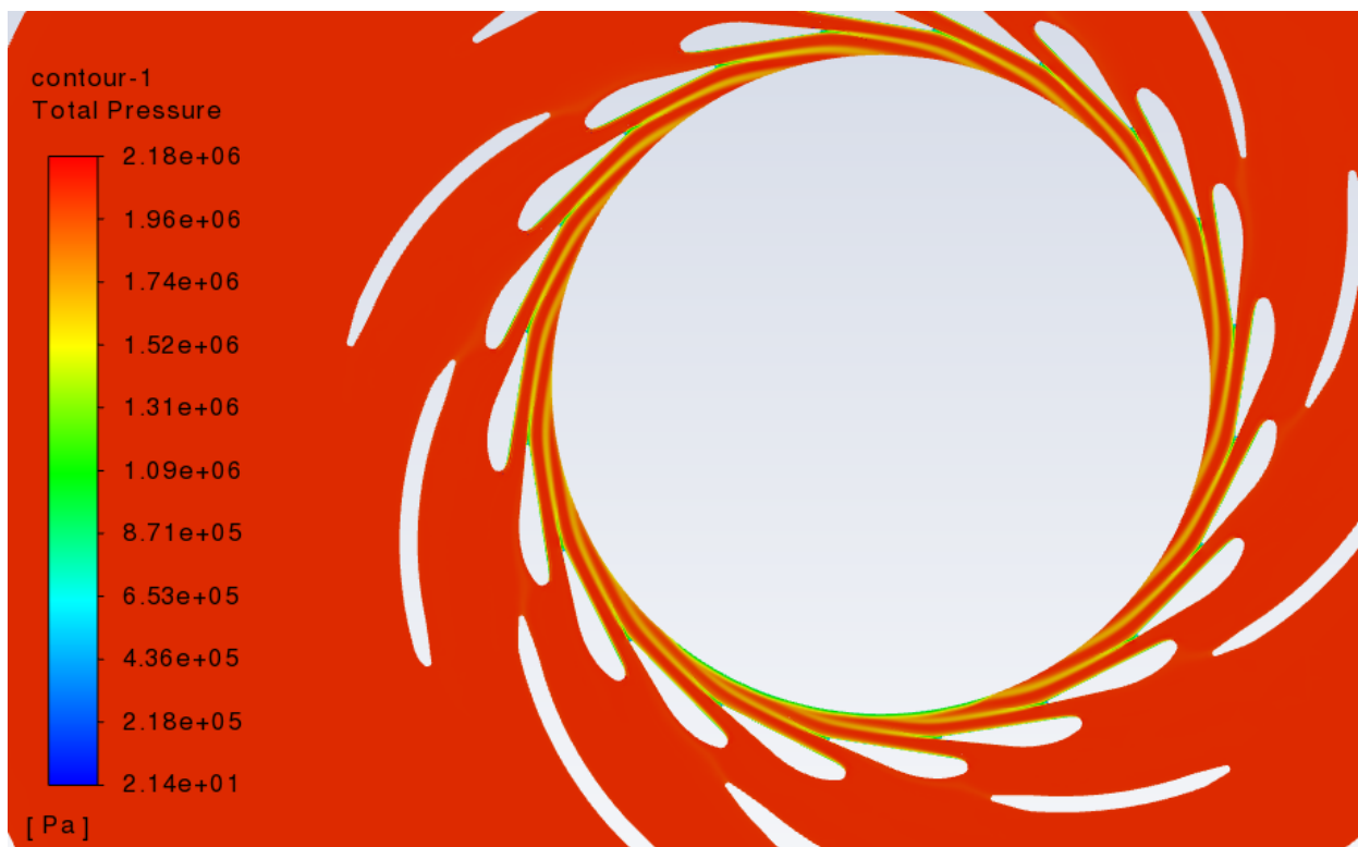
Slika 6-21 Konture totalnog tlaka u iso ravnini
