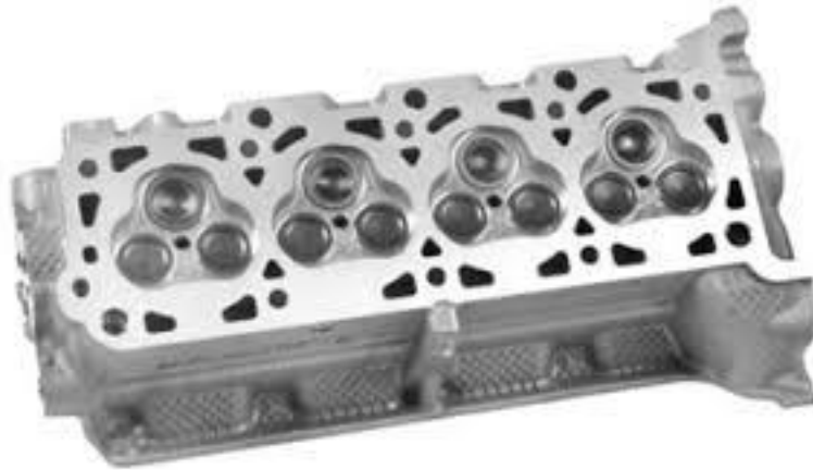
Slika 2.2. Konfiguracija s tri ventila po cilindru [4]
