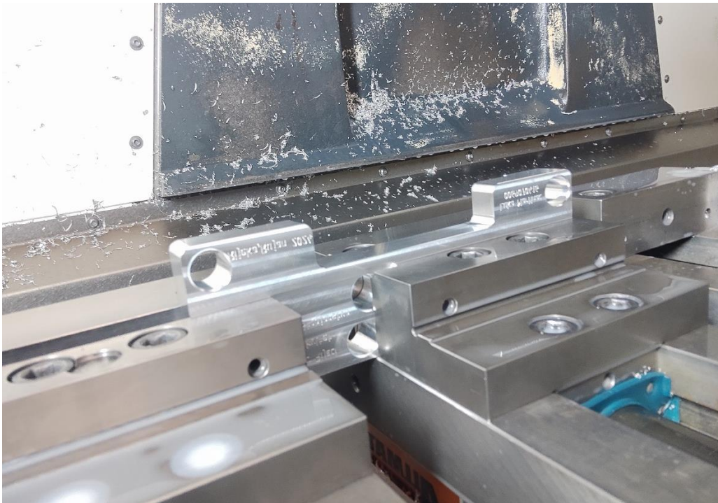
Slika 6: Izradak postavljen u dva LC125 škripa i spreman za treću operaciju
