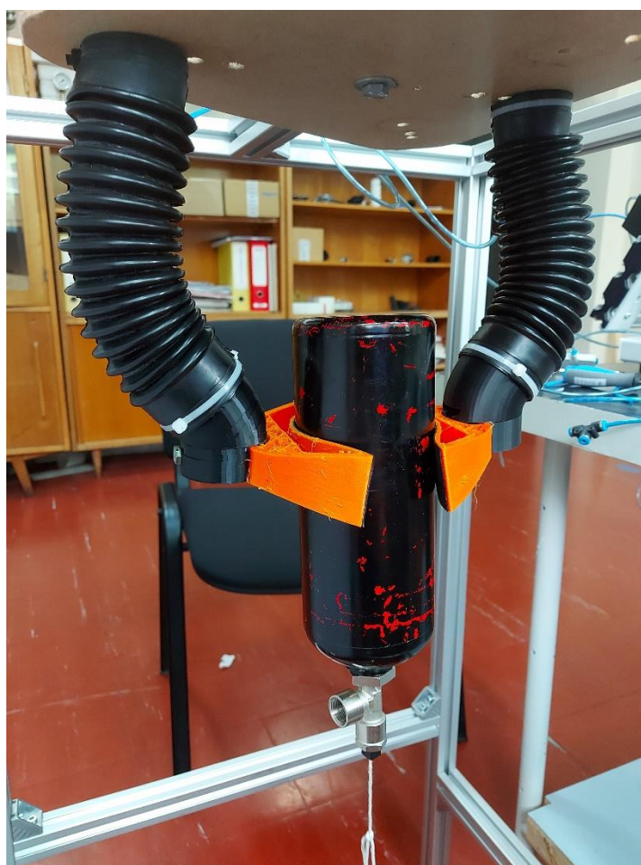
Slika 5.2.1. Montaža hvataljke koja drži spremnik i senzor sile
