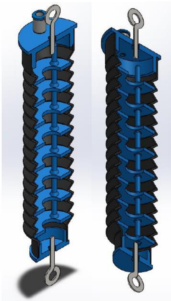
Slika 2.4.2. Idejno rješenje aktuatora sa kutnim savijanjem [9]
