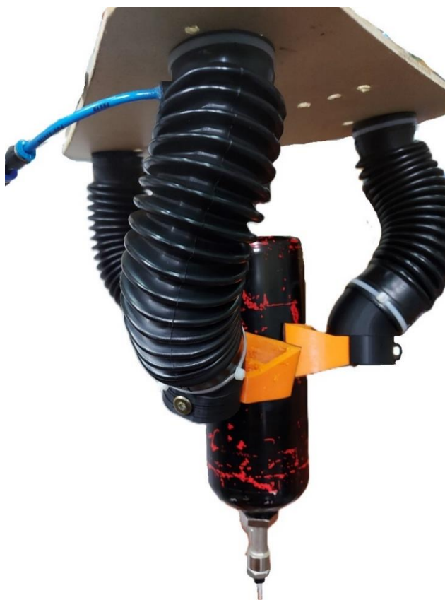
Slika 5.3.2. Deformacija hvataljke sa 3 aktuatora
