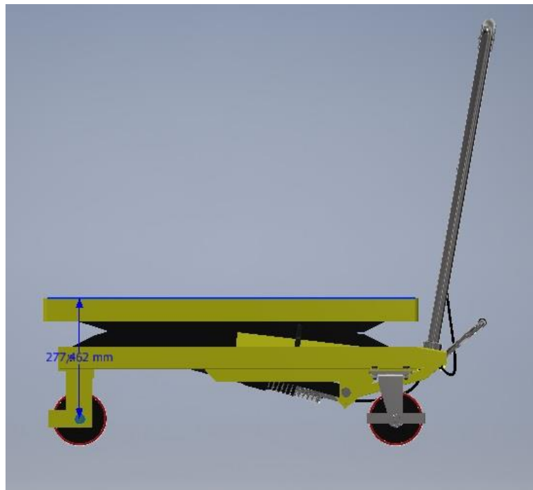
Slika 5.2. Visina platforme pri krajnje spušenom položaju
