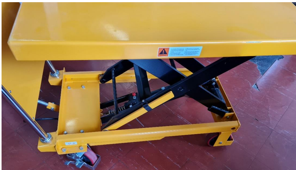
Slika 3.9. Spoj vanjskog para poluga s nosivom konstrukcijom
