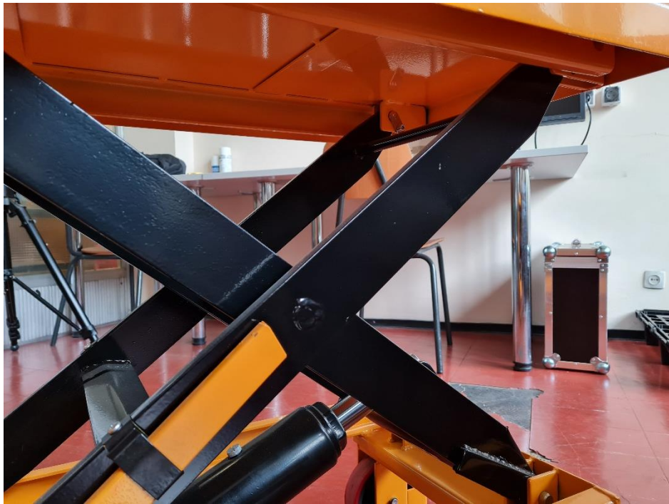
Slika 3.8. Spoj vanjskog para polugu i teretne platforme
