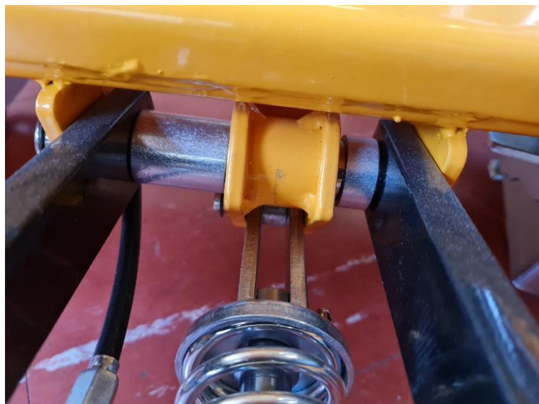
Slika 3.5. Spoj hidrauličkog cilindra i nosive konstrukcije
