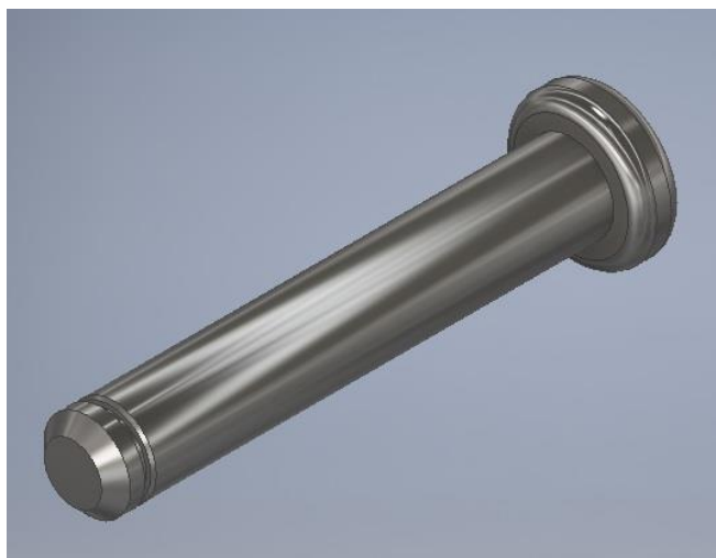
Slika 4.18. Svornjak \Phi 20 \times 125 mm
