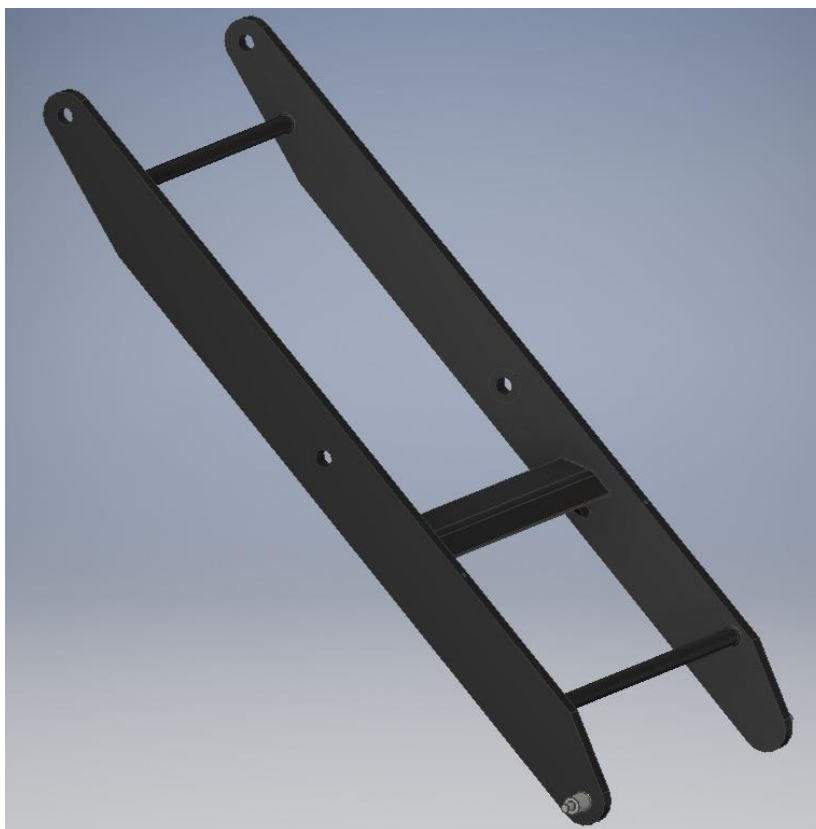
Slika 4.10. Vanjski par poluga škarastog mehanizma
