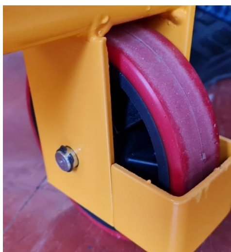
Slika 3.16. Osiguranje prednjih kotača
