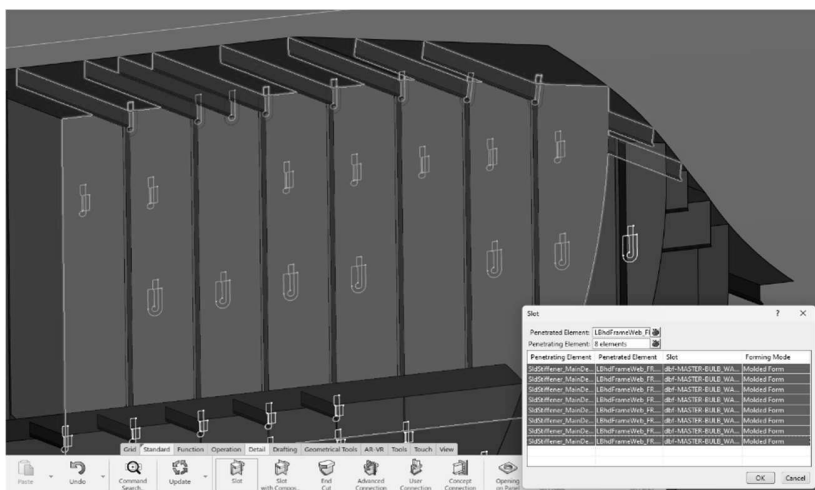
Slika 10.7. Prolaz za profile kroz vodonepropusnu pregradu
