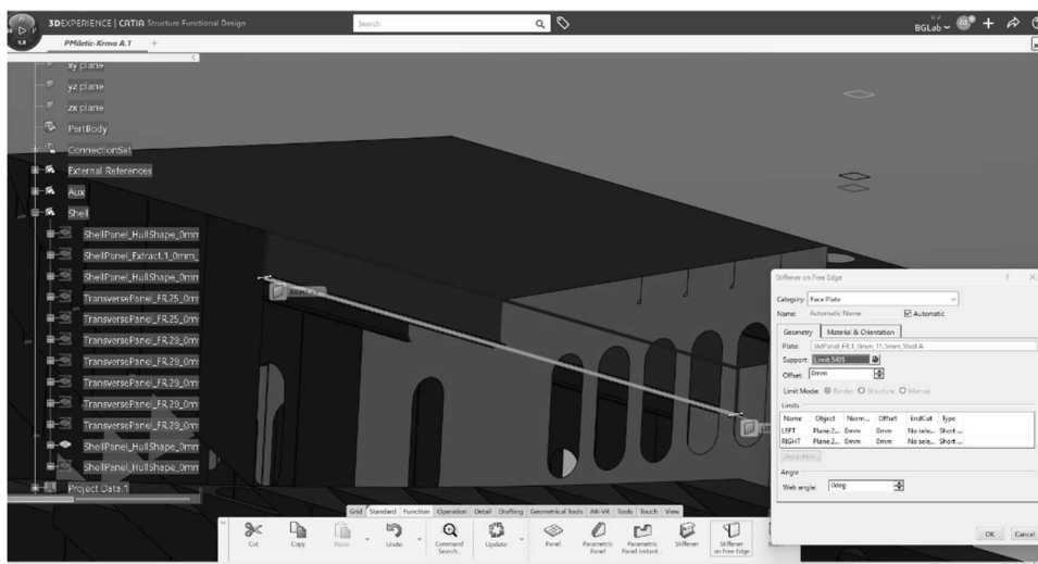
Slika 9.19. Korištenje naredbe "Stiffner on Free Edge"
