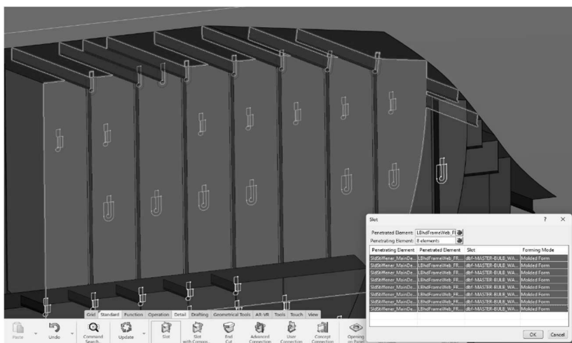
Slika 10.7. Prolaz za profile kroz vodonepropusnu pregradu
