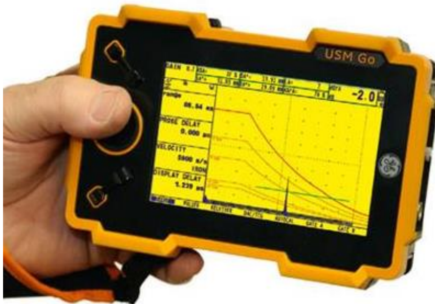
Slika 2.3. SUM Go ultrazvučni defektoskop [20]
