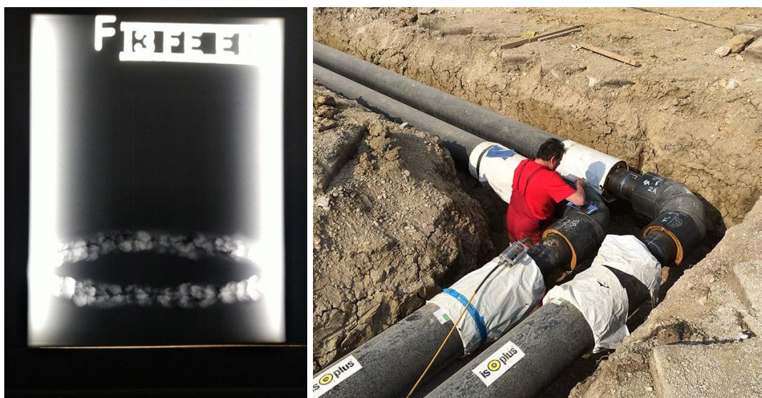
Slika 2.1. Radiografska snimka mjesta zavarenog spoja cijevi i postupak ispitivanja radiografijom [14]
