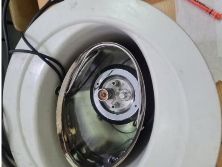
Slika 5.6 Posuda s vodom i kalorimetrijskom bombom
