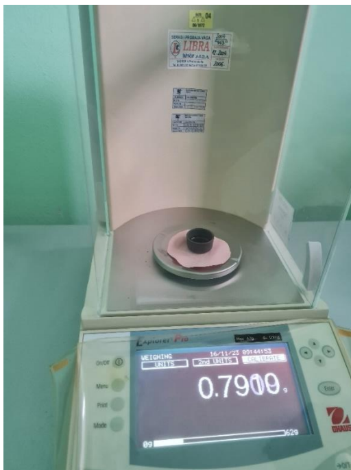
Slika 5.3 Mjerenje mase uzorka goriva
