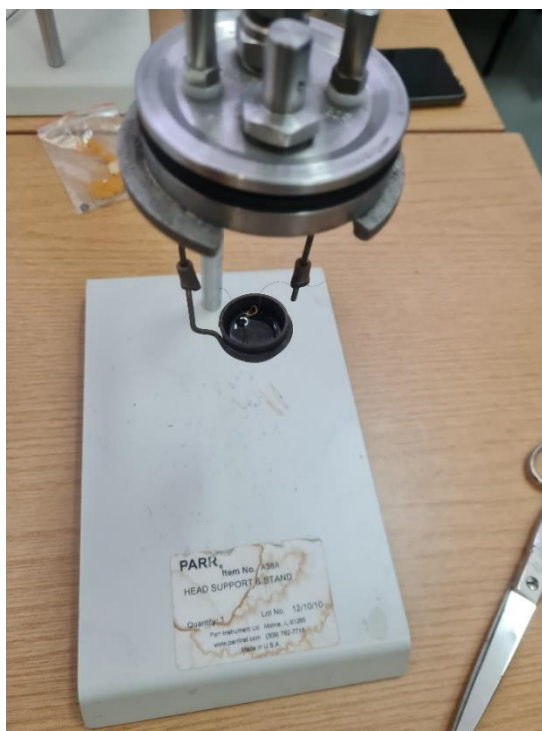
Slika 5.4 Poklopac kalorimetrijske bombe s pripremljenim uzorkom goriva
