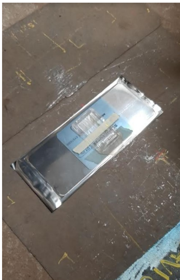
Slika 10.10. Postavljanje olovnih oznaka i IKR na radiografski film
