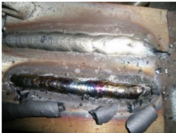
Slika 8.3. Pojava troske kod zavarenog spoja [46]
