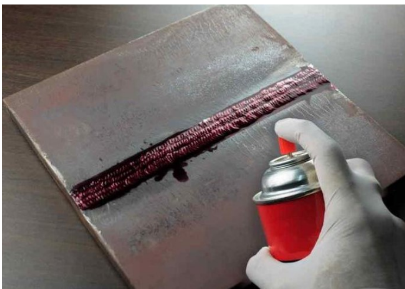
Slika 4.3. Ispitivanje pomoću obojenog penetranta [13]
